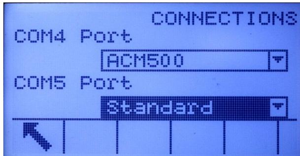
**Figura 3-18: Configuración del COM4 y COM5**
