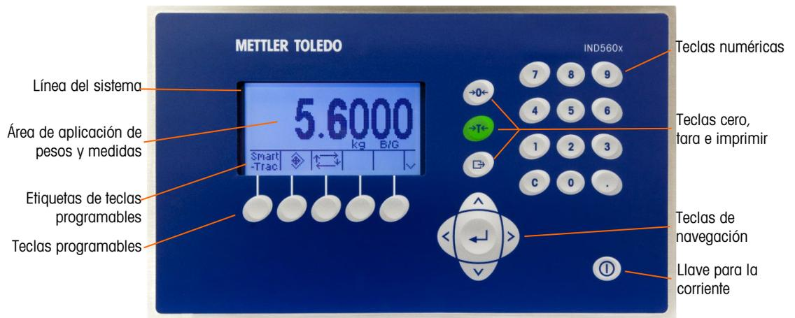
Figura 1-9: Pantalla y distribución del teclado del IND560x
