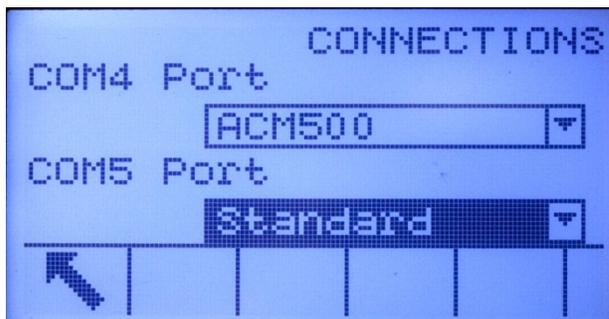
**Figura 3-12: Conexión del COM4 configurado para el ACM500**
