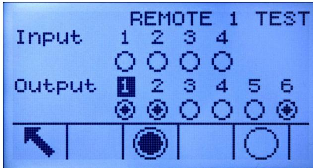
**Figura 4-5: Pantalla de prueba de E/S discontinuas**
