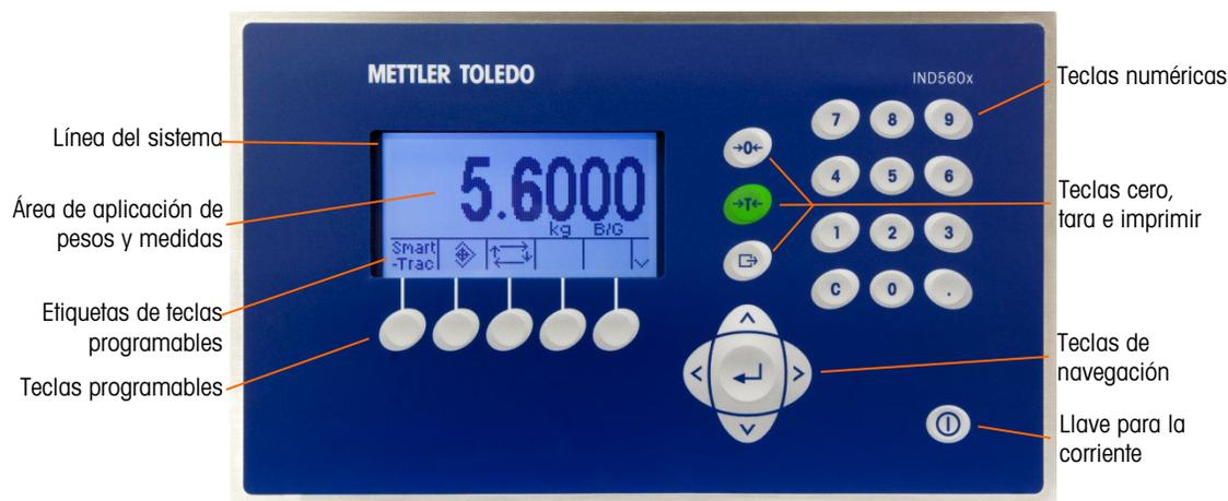
Figura 2-2: Pantalla de visualización y ubicación de las teclas
