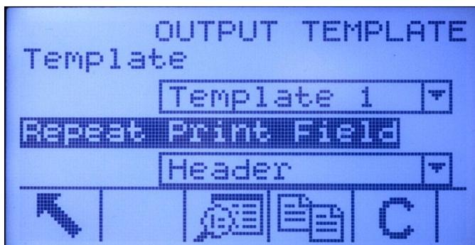
**Figura 3-17: Ajuste del campo de repetición de impresión**
