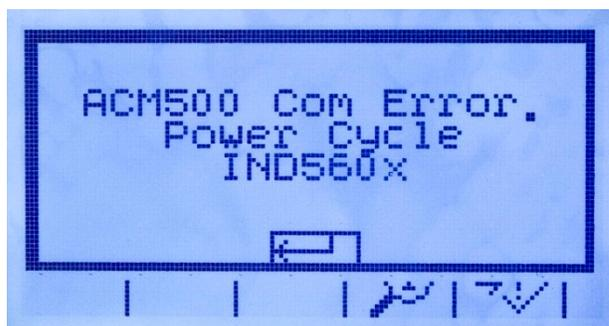
**Figura 3-20: Mensaje de error COM del ACM500**
