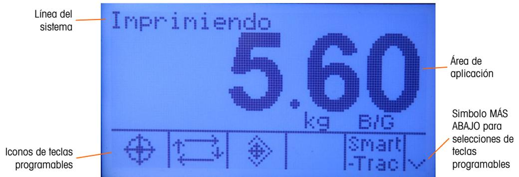
**Figura 2-9: Pantalla de operación con una mensaje del sistema**
