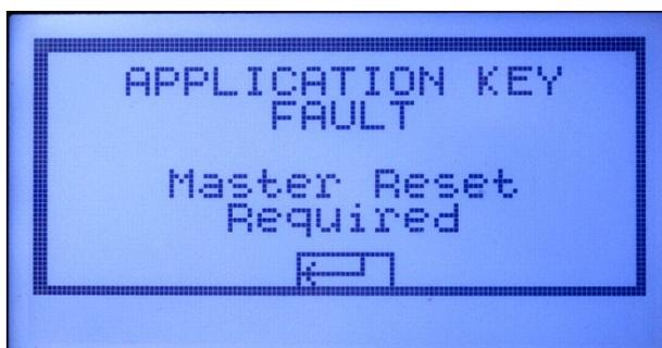
**Figura 4-1: Mensaje de falla de tecla de aplicación**
