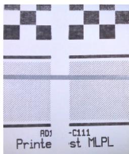
打印断码，需更换热敏打印头
