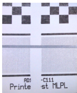
打印断码，需更换热敏打印头
