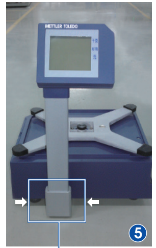
固定立杆两侧4颗螺栓
