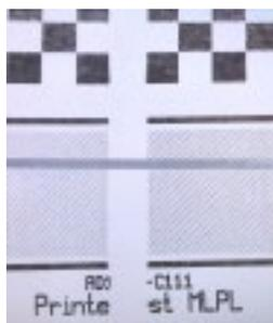
打印断码, 需更换热敏打印头
