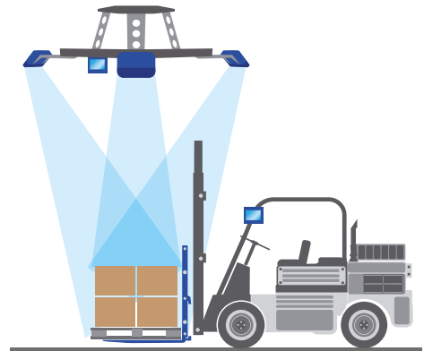
Statische Volumenmessung mit einer Gabelstaplerwaage
