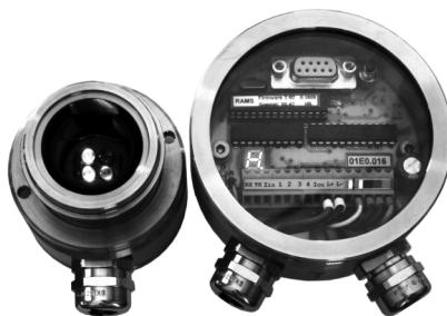
Der InPro 8300 RAMS TCS ist ein optisch arbeitendes Gerät zur Überwachung von Trübungs- oder Farbänderungen in flüssigen Produkten. Mit einer Steckbrücke wird festgelegt, ob das Gerät zur Trübungs- oder zur Farbunterscheidung verwendet werden soll. Hauptsächliches Anwendungsbereich ist die Erkennung von Phasenübergängen bei Produktwechseln oder Produktausschüben. Über einen Analogausgang 4–20 mA wird der Trübungs- bzw. der Farbverlauf an ein auswertendes Gerät weitergegeben.
