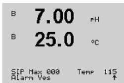
O limite de ciclos de SIP conta o número de ciclos de SIP. Se o limite (definido pelo usuário) for atingido, um alarme pode ser indicado é mostrado na tela. Através da interface FF é possível ler o limite de ciclos SIP pelo bloco de entrada discreta. A seguinte opção é possível:
