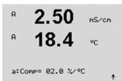
Se modo de compensação "Lin 25 °C" ou "Lin 20 °C" for selecionado, o fator de ajuste da leitura pode ser modificado após pressionar [ENTER] (Se estiver trabalhando na linha de medição 1 ou 2, pressione [ENTER] duas vezes).
