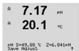
O visor mostra o fator de calibração de inclinação "S" e o fator de calibração de deslocamento "Z".
