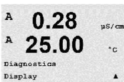
Todos os pixels do display acenderão durante 15 segundos para permitir resolução de problemas da tela. Após 15 segundos o transmissor retornará ao modo de medição normal ou pressione [ENTER] para sair mais cedo.
