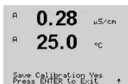
Pressionar a tecla [ENTER] após inserir o Ponto 2 fará aparecer uma tela de confirmação. Selecionar "Não" irá descartar os valores inseridos, selecionar "Sim" tornará os valores inseridos os atuais.
