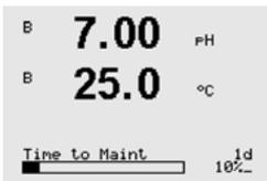
**Tempo até a Manutenção:** Esse temporizador mostra um Tempo até a Manutenção quando o próximo ciclo de limpeza deve ser realizado, para manter o melhor desempenho de medição possível. O Tempo até manutenção é indicado em dias (d) e em porcentagem (%). Para obter uma descrição do Tempo até manutenção, consulte a seção 8.4 "Configuração ISM". Para sensores de oxigênio, o Tempo até manutenção indica um ciclo de manutenção da membrana e do eletrólito.
