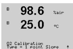
Selecione 1 ponto seguido por Slope or ZeroPt como o tipo de calibração. Pressione [ENTER].
