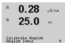
A entrada analógica pode ser calibrada em dois valores de corrente, ex.: 4 mA e 20 mA.
