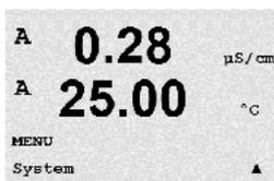
No modo de medição, pressione a tecla ◀. Pressione a tecla ▼ ou ▲ para navegar até “Sistema” – Menu e pressione [ENTER].
