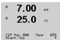
O limite de ciclos de CIP conta o número de ciclos de CIP. Se o limite (definido pelo usuário) for atingido, um alarme é mostrado na tela. Via interface FF é possível ler o limite de ciclos de CIP fornecidos pelo bloco de entrada discreta. A seguinte opção é possível:
