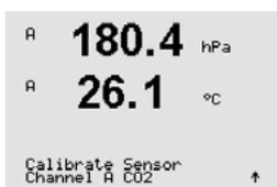
Accesse o modo de calibração de CO<sub>2</sub> como descrito na seção 7.1 "Acessar Modo de Calibração".
