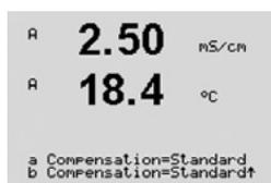
A **compensação Padrão** inclui compensação de efeitos de alta pureza não linear, além de impurezas convencionais de sal neutro e conforma-se às normas ASTM D1125 e D5391.
