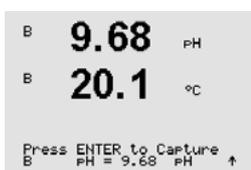
Tome uma amostra e pressione a tecla [ENTER] novamente para armazenar o valor de medição atual. Para mostrar o processo de calibração em andamento, A ou B (dependendo do canal) fica piscando no display.
