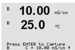
Tome uma amostra e pressione a tecla [ENTER] novamente para armazenar o valor de medição atual.
