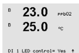
O modo de operação do LED do sensor também pode ser influenciado pelo sinal de entrada digital DI1 do transmissor. Se o parâmetro “DI 1 LED control” for definido para “Sim”, o LED é desligado se DI1 estiver ativo. Se “DI 1 LED control” for definido para “Não”, o sinal de DI1 vai agora influenciar o modo de operação do LED do sensor.
