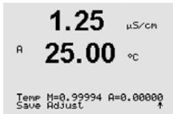
Depois de uma Calibração bem sucedida, os valores da calibração são assumidos (Ajuste) ou descartados (Calibrar ou Abortar).
