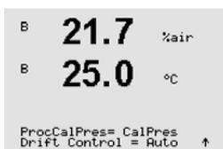
Para o algoritmo de calibração do processo, a pressão aplicada (ProcCalPres) deverá ser definida. Tanto o valor da pressão do processo (PresProc) como a pressão de calibração (Pres-Cal) pode ser utilizada. A respectiva pressão aplicável durante o processo de calibração deverá ser utilizada para o algoritmo.
