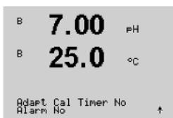
Ativação do **Temporizador de Cal adaptativo:** Esse temporizador estima quando a próxima calibração deverá ser realizada para manter o melhor desempenho de medição possível. O temporizador é influenciado por alterações significativas nos parâmetros DLI.
