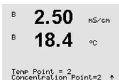
Insira a quantidade desejada de pontos de temperatura (**Ponto de Temp**) e **Pontos de Concentração**.
