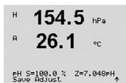
Assim que os critérios de estabilização forem cumpridos, a tela muda para mostrar o fator "S" de calibração de declive e o fator "Z" de calibração de compensação.
