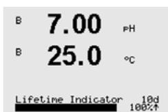
**Temporizador de Cal adaptativo:** Esse temporizador mostra um Temporizador de Cal adaptativo quando a próxima calibração deve ser realizada, para manter o melhor desempenho de medição possível. O Temporizador de Cal adaptativo é indicado em dias (d) e em porcentagem (%). Para obter uma descrição do Temporizador de Cal adaptativo, consulte a seção 8.4 "Configuração ISM".
