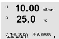
Após a calibração o Multiplicador ou fator de calibração de slope "M" e o Somador ou fator de calibração de compensação "A" são exibidos.
