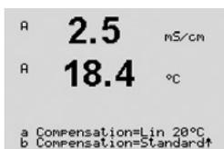
A **compensação Linear 20 °C** ajusta a leitura por um coeficiente ou fator expresso como uma % / °C (desvio de 20 °C). Use somente se a solução tiver um coeficiente de temperatura linear bem caracterizado.
