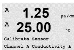
Entre no Modo de calibração do sensor de condutividade como descrito na seção 7.1. "Acessar Modo de Calibração".
