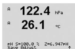
Agora a tela mostra o fator de calibração de declive "S" e o fator de calibração de compensação "Z".
