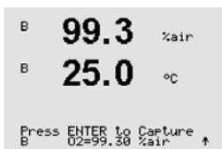
Tome uma amostra e pressione a tecla [ENTER] novamente para armazenar o valor de medição atual. Para mostrar o processo de calibração em andamento, A ou B (dependendo do canal) fica piscando na tela.
