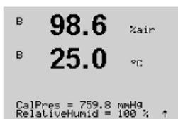
Ajuste a pressão de calibração (CalPres) e a umidade relativa (Umid Relativa) aplicados durante a calibração. Pressione [ENTER].
