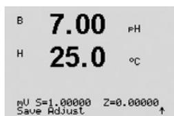
O visor mostra o fator de calibração de inclinação "S" e o fator de calibração de deslocamento "Z".
