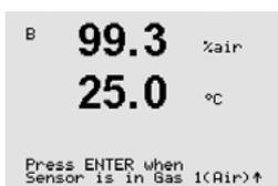
Coloque o sensor na solução resp. do gás de calibração (por exemplo, ar). Pressione [ENTER].
