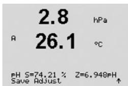
A tela mostra o fator de calibração de declive S e o fator de calibração de compensação Z.
