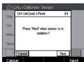
Coloque el electrodo en la solución de referencia y pulse el botón "Next" (Siguiente).
