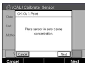
Coloque el sensor en el gas de calibración, como puede ser el aire, y pulse el botón "Next" (Siguiente).
