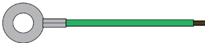
Cable de conexión a tierra con terminal
