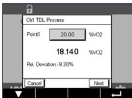
El M400 comprueba la desviación de la señal de medición y continúa con la calibración en cuanto la señal es lo suficientemente estable.
