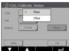
Pulse el campo de entrada de la derecha para el parámetro **Method** (Método). Seleccione la calibración "Slope" (Pendiente) u "Offset" (Desviación) pulsando el campo correspondiente.
