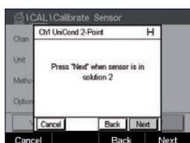
Coloque el electrodo en la segunda solución de referencia y pulse el botón "Next" (Siguiente).
