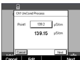
Pulse el campo de entrada de **Point 1** (Punto1) e introduzca el valor de conductividad de la muestra. Pulse el botón "Next" (Siguiente) para iniciar el cálculo de los resultados de la calibración.
