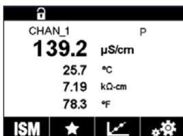
Una vez determinado el valor de conductividad de la muestra, pulse otra vez el icono de calibración de la pantalla de menú.
