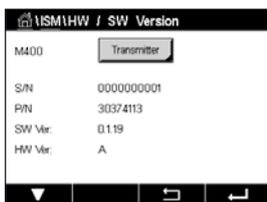
En la pantalla se muestran los datos del transmisor. Pulse el campo de entrada en la línea de M400. Para seleccionar los datos de la tarjeta deseada o del propio transmisor, pulse el campo correspondiente.
