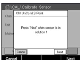
Coloque el electrodo en la primera solución de referencia y pulse el botón "Next" (Siguiente).
