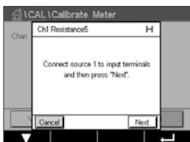
Conecte la fuente 1 a los terminales de entrada. Cada intervalo de resistencia tiene una calibración de dos puntos.
