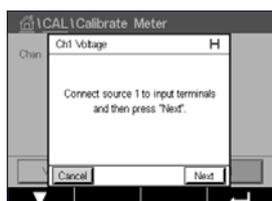
Conecte la fuente 1 a los terminales de entrada. Pulse el botón "Next" (Siguiente) para iniciar el proceso de calibración.
