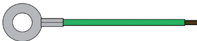
Cavo di messa a terra con capocorda
