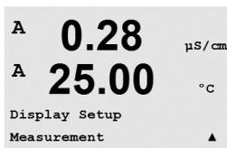
Selezione della modalità «Errori». Se era impostata su «Visualizza» quando si è verificato un allarme, viene visualizzato il messaggio «Guasto – seleziona Enter» nella linea 4 quando si verifica un allarme in modalità misura normale.
