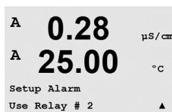
Usare i tasti ◀ e ▶ per navigare fino a «Uso relè #». Usare il tasto ▲ o ▼ per selezionare un relè da utilizzare per l'allarme e premere [ENTER].
