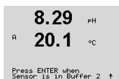
Una volta stabilizzate le condizioni, il visore cambia e chiede di collocare l'elettrodo nella seconda soluzione tampone.
