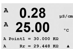
Inserire il valore per il punto 2 della calibrazione secondo il resistore collegato all'ingresso di misura di riferimento del pH.
