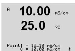
Inserire il valore di conduttività del campione e poi premere il tasto [ENTER] per avviare il calcolo dei risultati della calibrazione.
