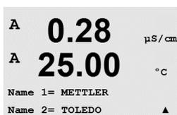
Usare i tasti ◀ e ▶ per navigare tra i numeri da modificare. Usare i tasti ▲ e ▼ per modificare il carattere da visualizzare. Una volta inseriti tutti i numeri di entrambi i canali del visore, premere [ENTER] per visualizzare il dialogo di salvataggio modifiche.
