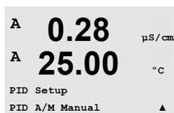
Questo menu permette di selezionare il funzionamento manuale o automatico. Selezionare il funzionamento automatico o manuale. Premendo il tasto [ENTER] compare il dialogo per il salvataggio delle modifiche.
