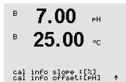
Possono essere selezionate le unità per la pendenza e il punto zero, che saranno visualizzate sul visore. L'impostazione predefinita per l'unità della pendenza è [%] e può essere cambiata in [pH/mV]. L'impostazione predefinita per l'unità del punto zero è [pH] e può essere cambiata in [mV]. Usare il tasto ► per spostarsi al successivo campo di ingresso e selezionare l'unità mediante il tasto ▲ o ▼.
