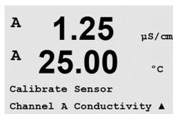
Entrare nella modalità di calibrazione del sensore di conduttività come descritto nella sezione 7.1 «Entrare in modalità Calibrazione».
