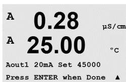
Collegare un galvanometro accurato ai terminali di uscita analogica e regolare il numero a cinque cifre sul visore fino a quando il galvanometro non mostra 4,00 mA e ripetere per 20,00 mA.
