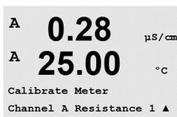
Navigare fino alla schermata Calibrare strumento e selezionare il canale A o B, e Resistenza 1, determinando che il trasmettitore è pronto per calibrare il resistore del primo intervallo. Si può modificare questa resistenza, selezionando l'intervallo da 1 a 5. Ogni intervallo di resistenza consiste in una calibrazione a due punti.
