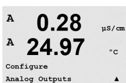
Entrare in modalità configurazione come descritto nella sezione 8.1 «Entrare in modalità configurazione» e navigare nel menu «Uscite analogiche» usando il tasto ▲ o ▼.
