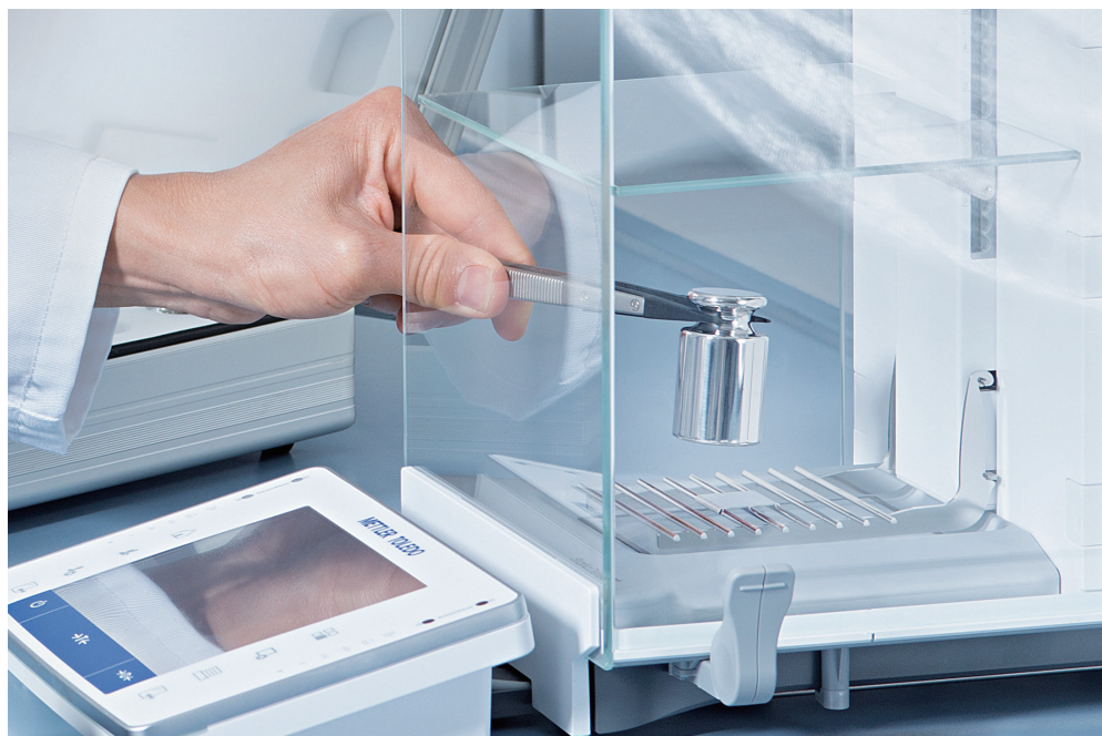
先端がカーボン製のピンセットによる適正な分銅の取り扱い
