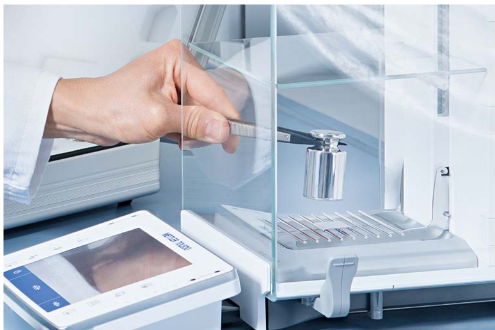
Prawidłowe przenoszenie wzorca masy za pomocą pincety z węglowymi końcówkami
