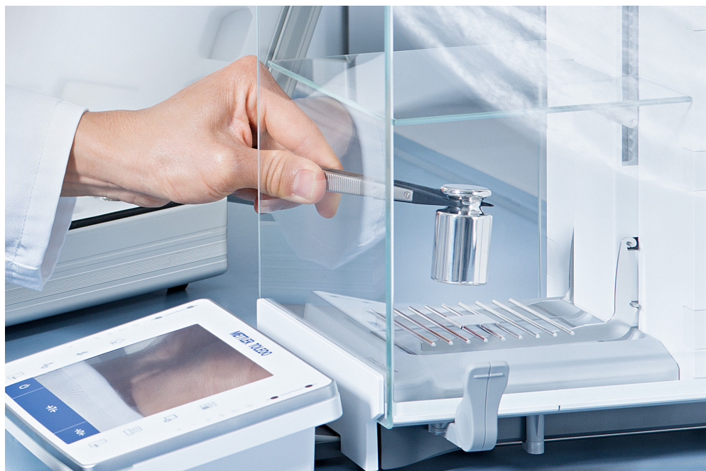
Správná manipulace se závažím pomocí pinzety s uhlíkovými koncovkami
