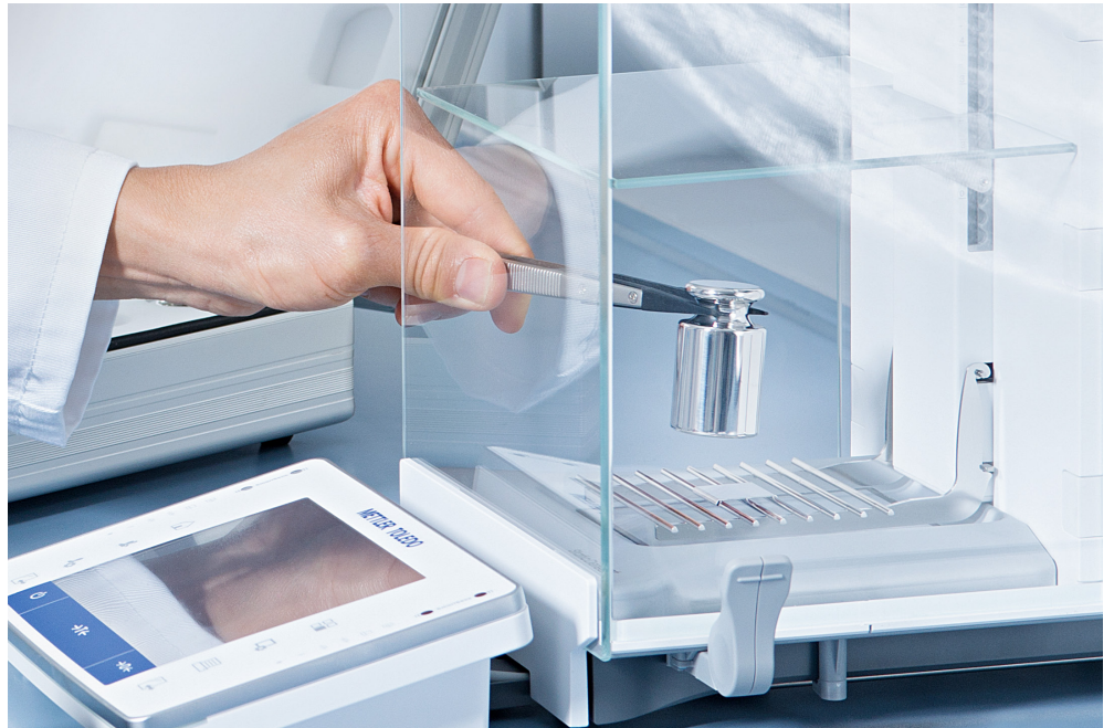
Manipulación correcta de las pesas con pinzas con puntas de carbono
