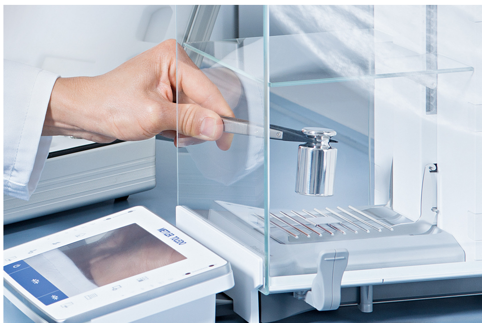
Manipolazione corretta dei pesi con pinzette in carbonio
