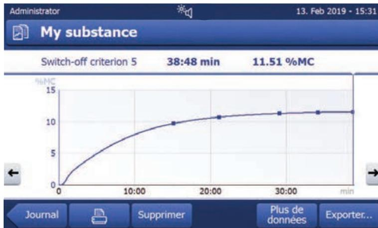
Dans la visualisation graphique du procédé de test, il est possible d'accéder aux détails des différents SOC (temps et % TH au point d'accès) :
