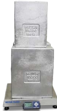
Cân BC được kiểm định ở mức 500% công suất của nó.
