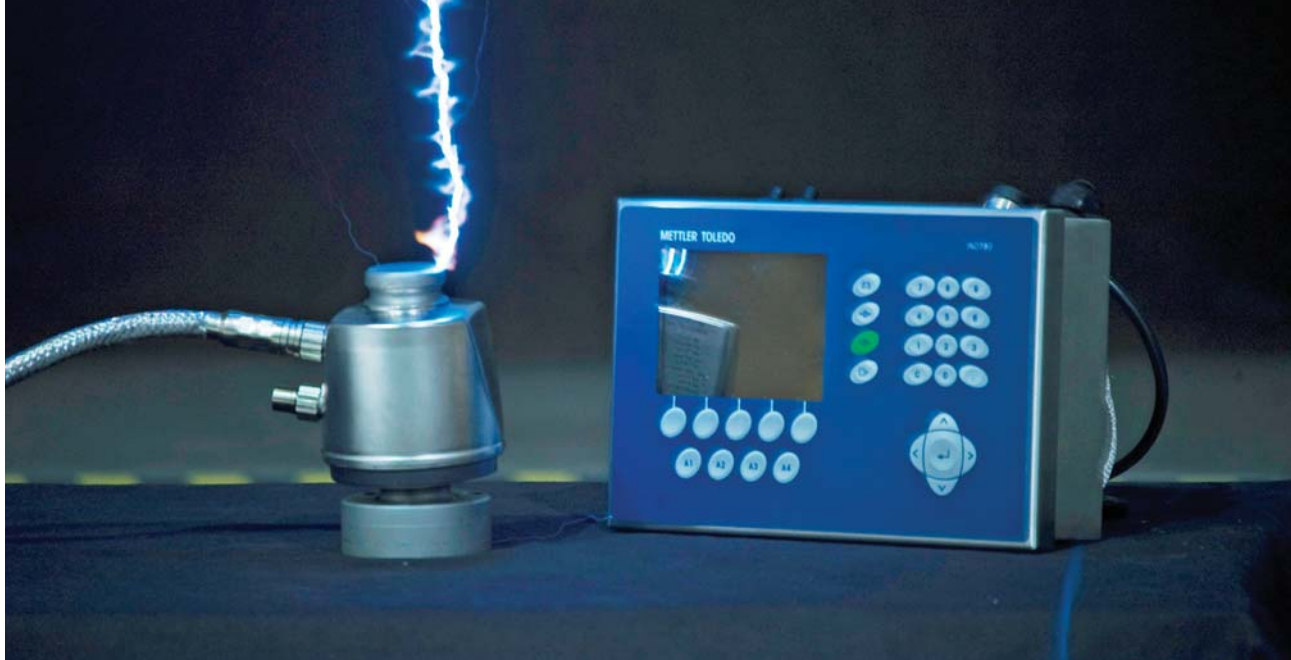
一个和仪表连接在一起的POWERCELL PDX称重传感器正在做雷击测试。
