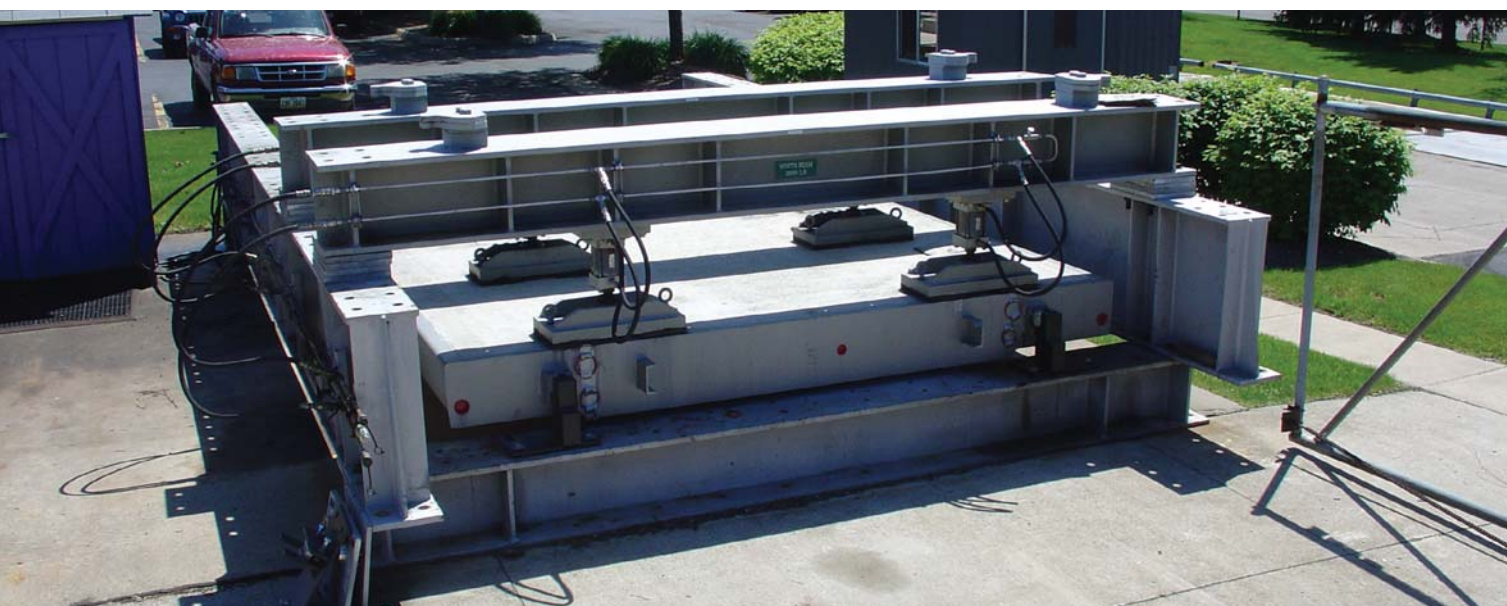
梅特勒-托利多的汽车衡秤体模块疲劳寿命试验机, 以此来模拟秤体所受的汽车载荷。
