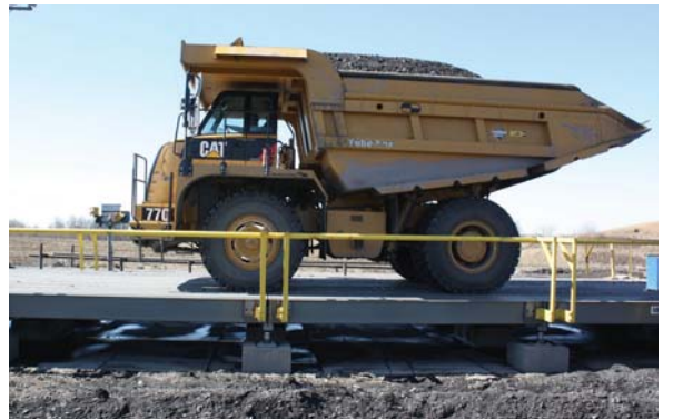
一台无基坑(侧面敞开式)汽车衡设计更易于维护
