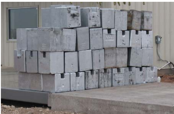
汽车衡测试所用的砝码
