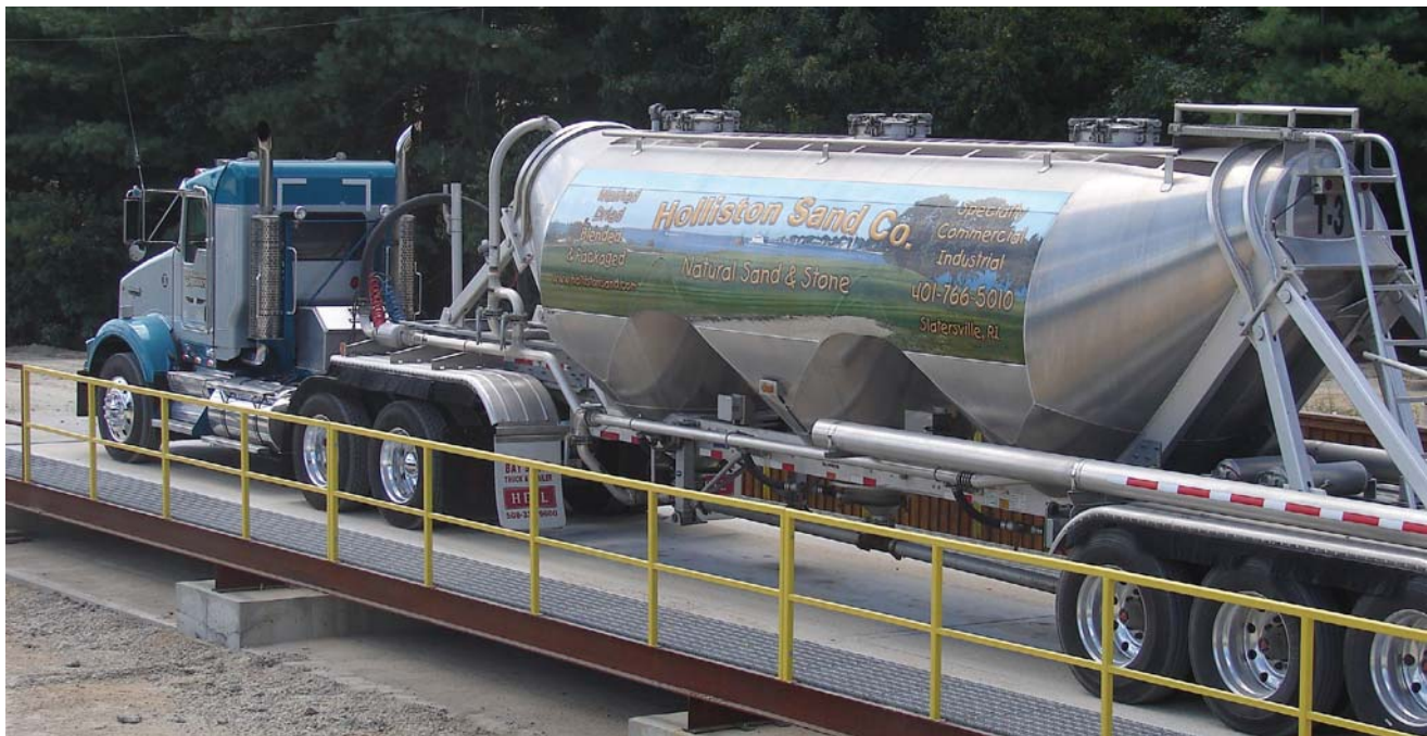
通过称重来进行大宗货物的买卖就意味着这台汽车衡必须遵循有关贸易结算的法规。
