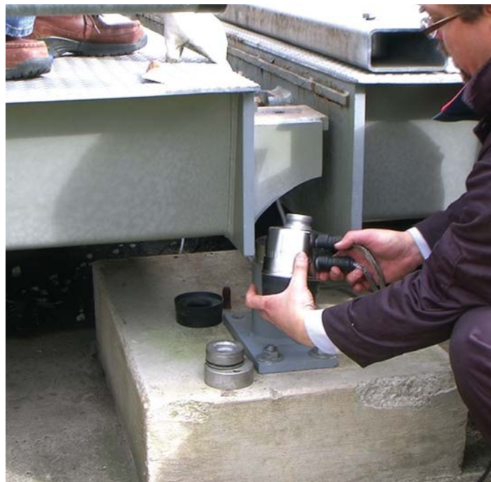
定期检查传感器, 连接件和其它关键件的磨损情况。
