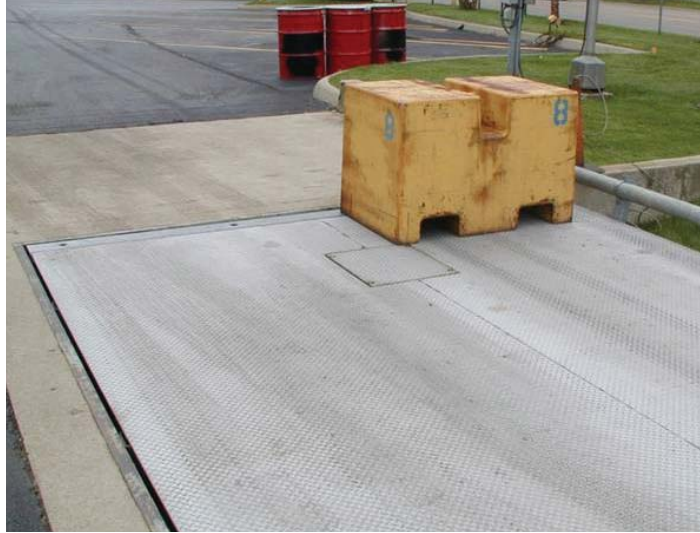
测试砝码放置在汽车衡的一个角。
