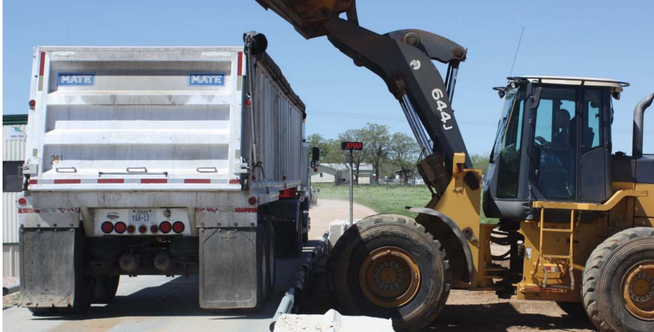
通过安装在现场的远程大屏幕显示器的信息，这辆卡车可以被加载到最大允许装载量。
