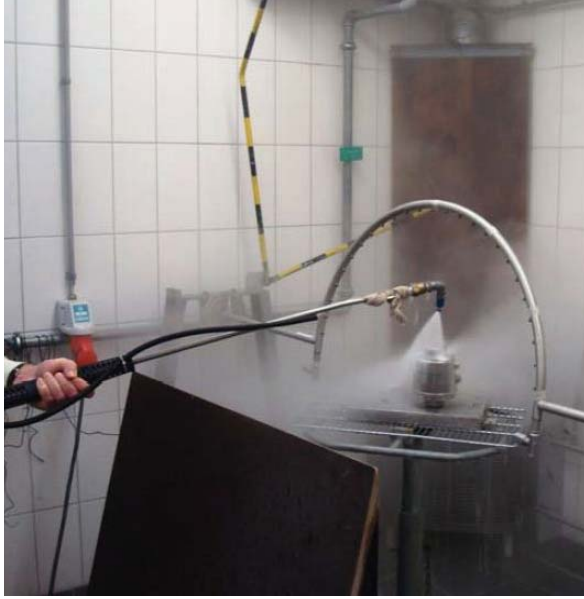
一个POWERCELL PDX称重传感器正在经受高压喷水-IP69K测试。
