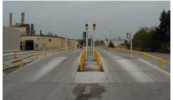
安装在汽车衡上的护栏,通过螺栓或焊接连接在汽车衡的侧面,指引汽车驾驶员安全上下秤。
