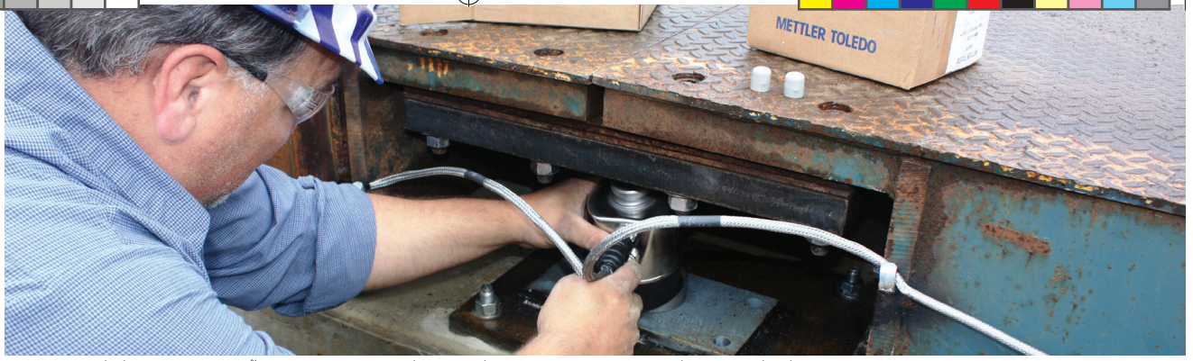
อัปเกรดแท่นชั่งที่มีอยู่ได้โดยการติดตั้งระบบโหลดเซลล์ใหม่ ซึ่งจะช่วยให้มีความแม่นยำและความน่าเชื่อถือของเครื่องชั่ง
