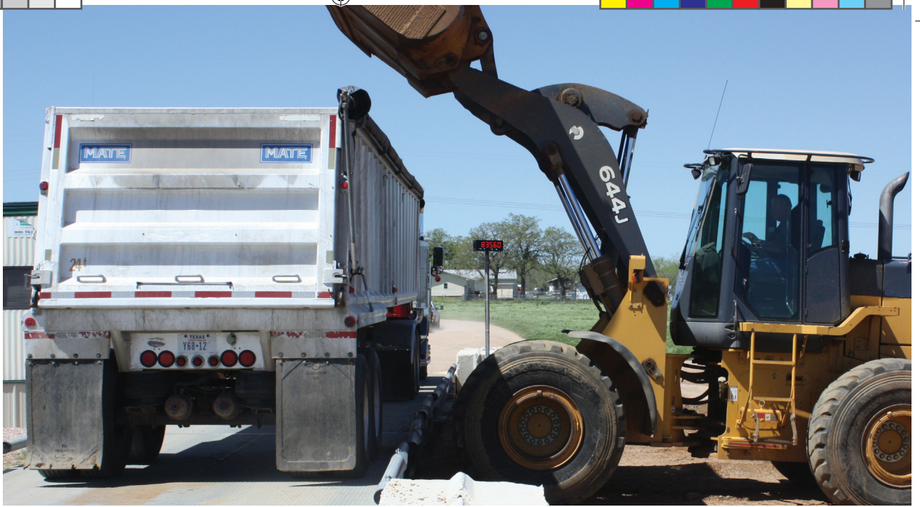
ด้วยหน้าจอแสดงน้ำหนักในระยะไกลที่ติดตั้งไว้ให้ผู้ใช้ควบคุมรถได้ดู รถบรรทุกนี้จะสามารถบรรจุสินค้าได้อย่างแม่นยำตามข้อกำหนดน้ำหนักสูงสุดที่รถวิ่งได้บนท้องถนน
