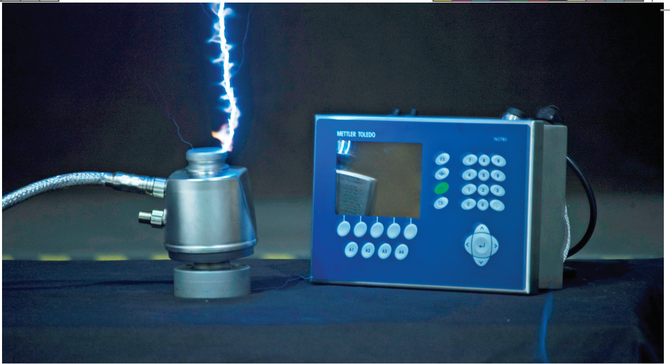
โพลดเซลล์ POWERCELL® PDX® เชื่อมต่อกับหน้าจอเครื่องชั่ง IND780 ระหว่างการทดสอบเกี่ยวกับฟ้าผ่า
