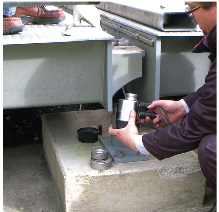
ตรวจสอบโหลดเซลล์ เบ้าบนและล่างที่ใช้ประกอบโหลดเซลล์ และชิ้นส่วนที่เสี่ยงต่อการสึกหรออื่น ๆ ตามกำหนดเวลา
