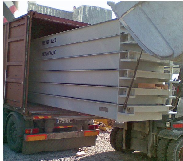
ผู้ผลิตบางรายอาจเสนอการจัดส่งเครื่องชั่งที่ใส่ในภาชนะบรรจุ เพื่อทำให้การจัดส่งเครื่องชั่งในระยะทางไกลหรือไปยังพื้นที่ห่างไกล เป็นไปด้วยความเรียบร้อย
