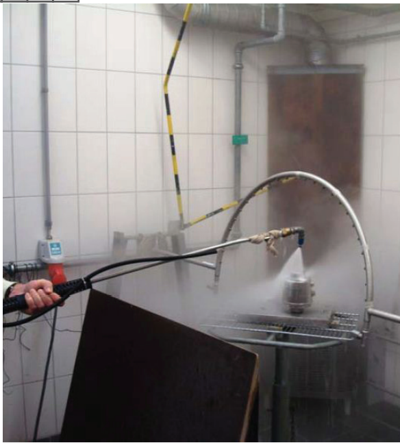
โพลดเซลล์ POWERCELL® PDX® ได้รับการทดสอบระดับ IP69K ด้วยสเปรย์อัดความดัน
