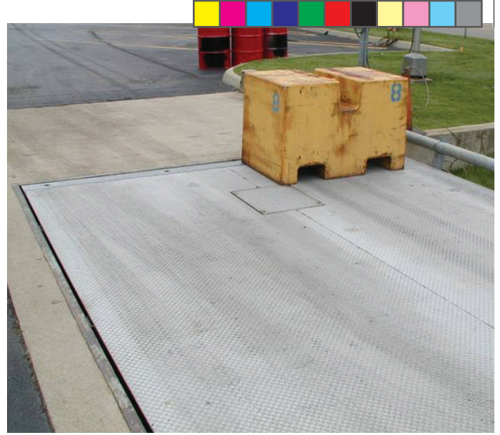
ตุ้มน้ำหนักทดสอบบนมุมของเครื่องชั่ง
