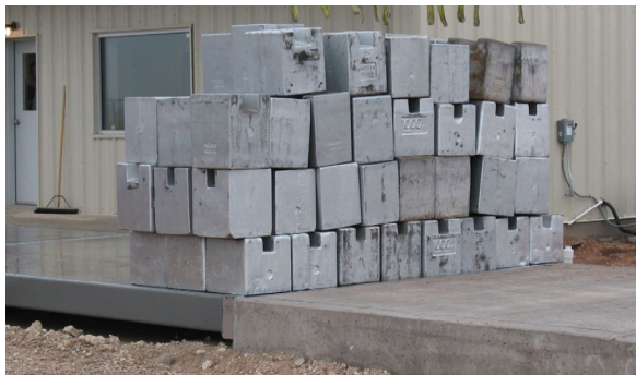
ตุ้มน้ำหนักสำหรับทดสอบบนเครื่องซึ่งรถบรรทุก
