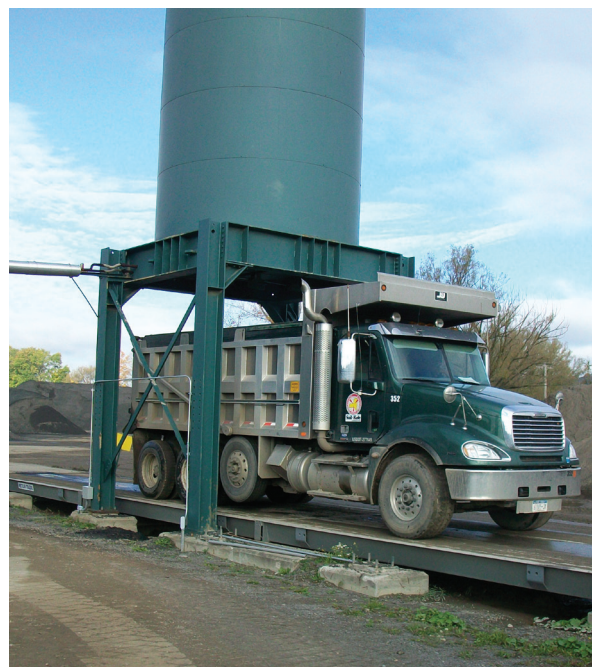
การดำเนินงานบรรจุอาจใช้เครื่องชั่งรถบรรทุกเป็นตัวเลือกหลักสำหรับการจ่ายสินค้าออก
