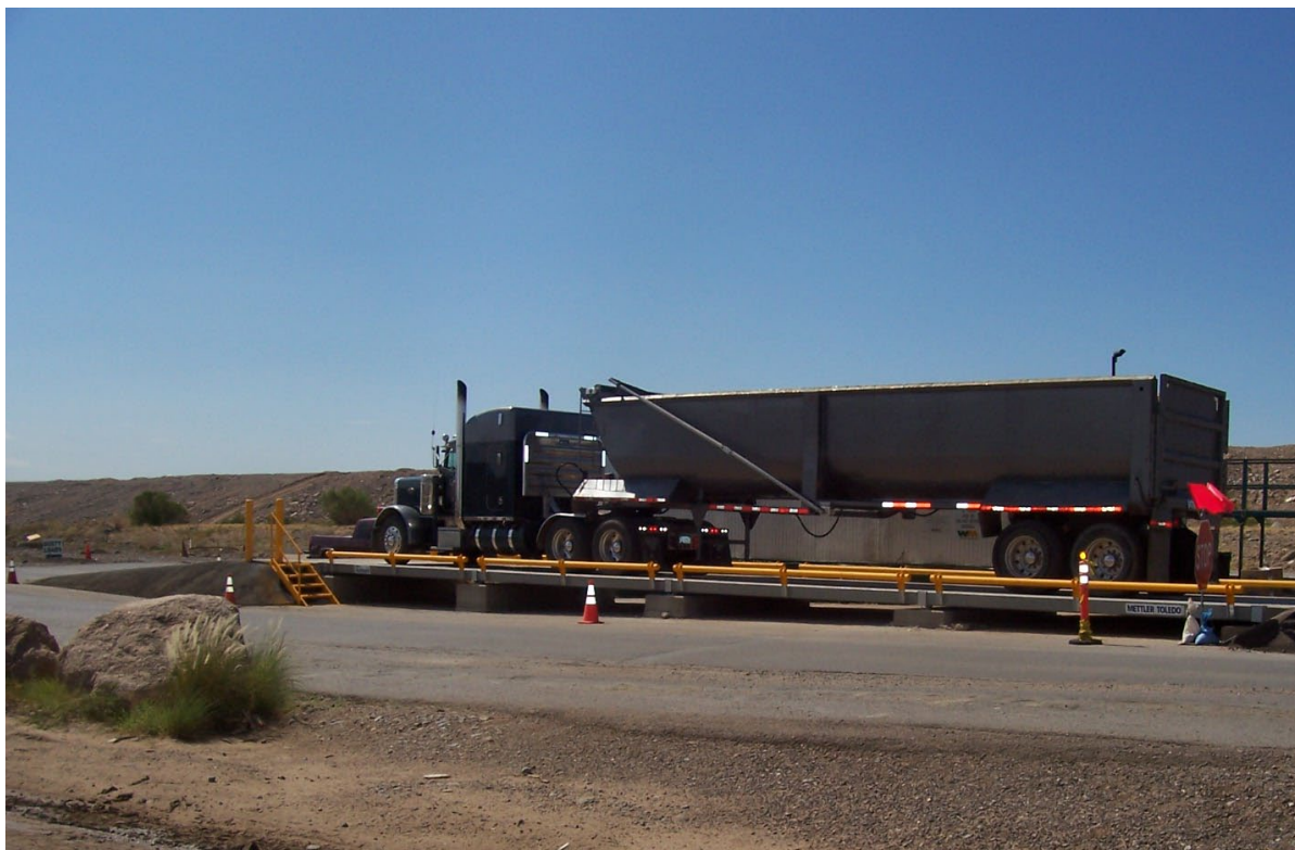
スケールの場所を清潔に保つことで、ゴミによる計量エラーを防ぐことができます
