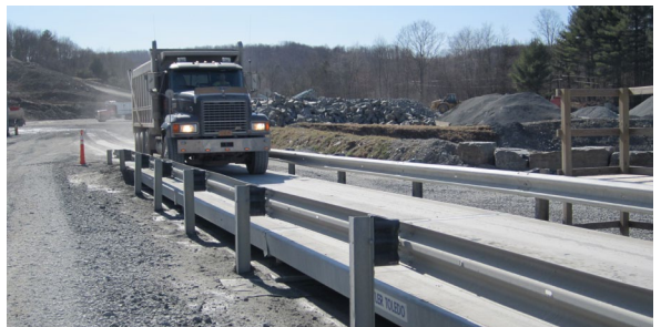
これらのスタンドアロンガイドレールはスケールに沿って地面に設置されて、強度を高め、トラックがスケールのサイドから飛び出すのを防ぎます
