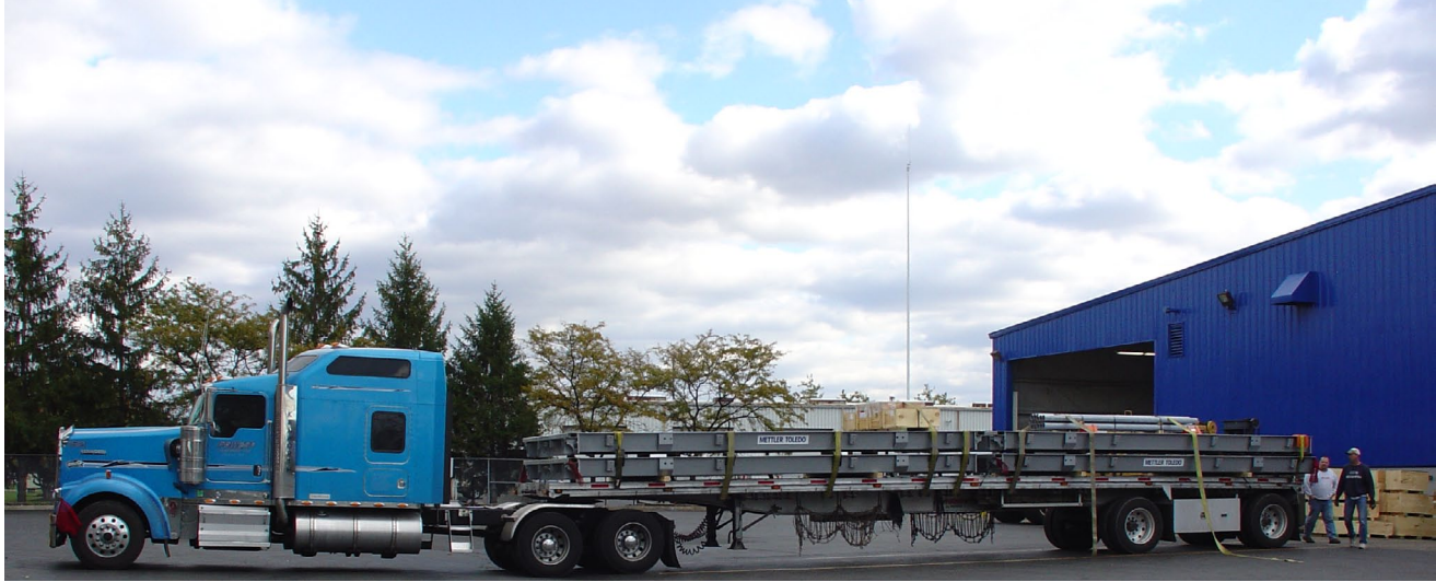
ウェイブリッジをフラットトレーラーで運搬する場合、モジュールの幅のせいでトラックに「過積載」の表示が必要な場合があります。
