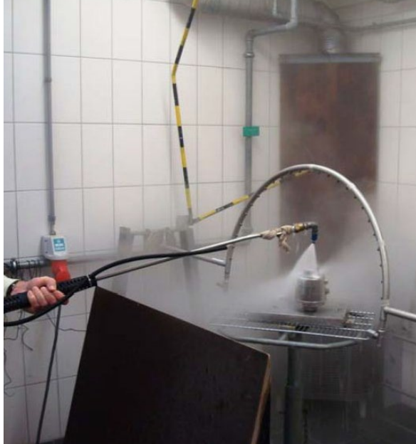
加圧散水による IP69K 試験を受ける POWERCELL PDX
