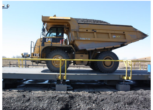
オープンサイドスケールの設計は保守性に優れています
