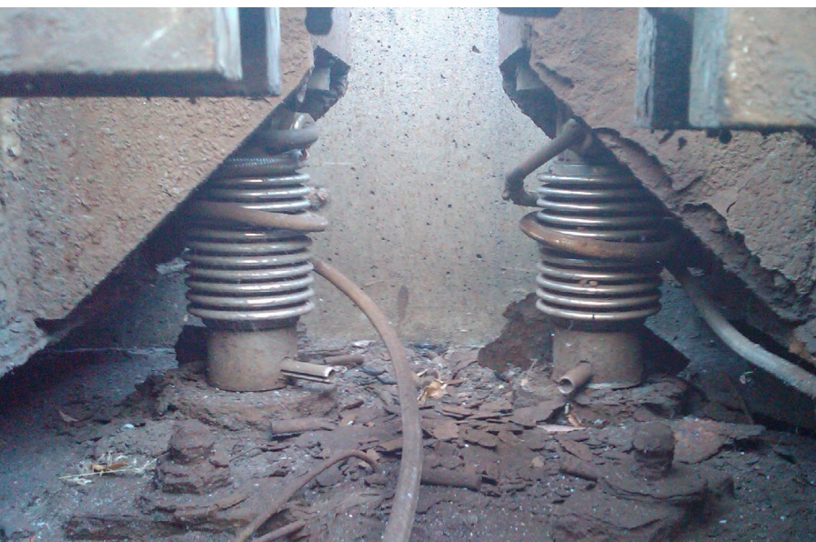
圧縮型ロードセルの回転防止機能が不適切な場合、最終的にロードセルにケーブルが巻き付いて切れます。
