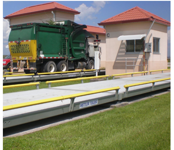
スケールハウスは、スケールの操作、トランザクション処理、サイトのセキュリティなど複数の目的で機能します
