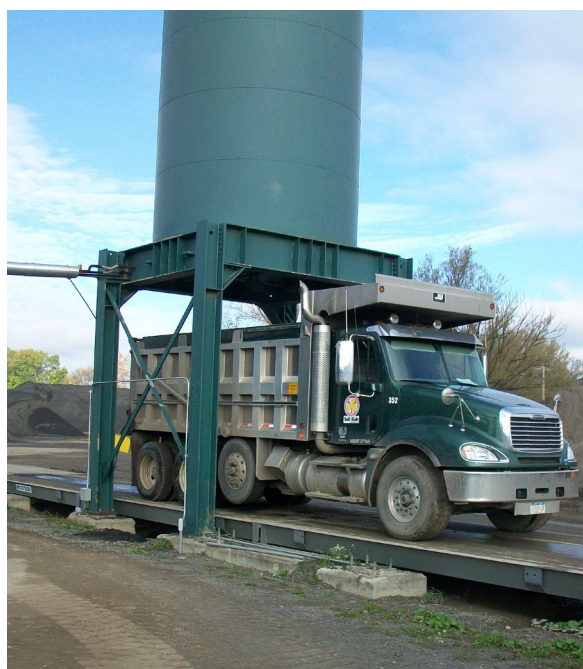
充填操作では、注入量の主な測定にトラックスケールを使用場合があります
