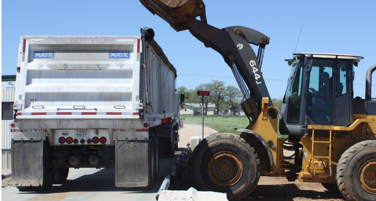
ローダーオペレータのビューに取り付けたりモート重量ディスプレイにより、このトラックは最大道路走行重量制限まで充填できます
