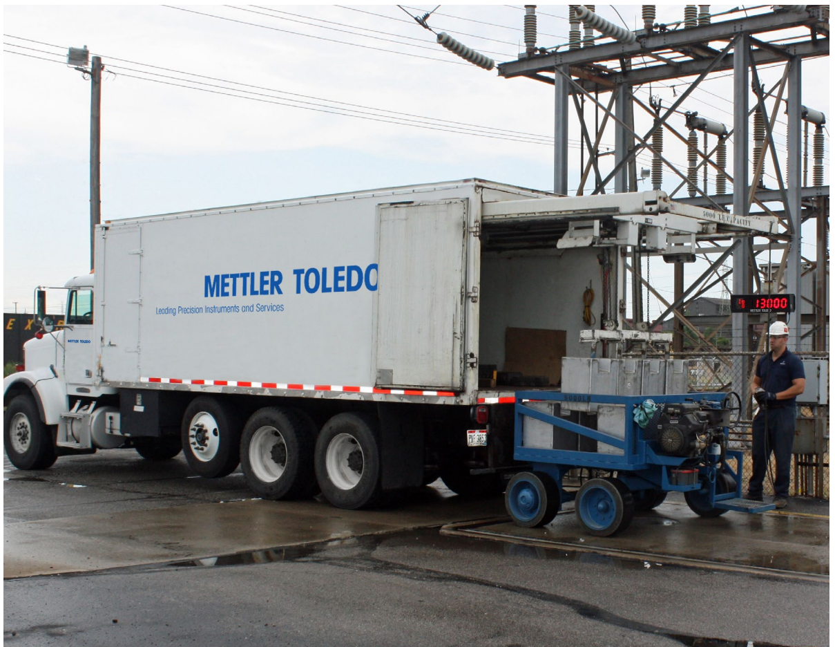
校正検査は、電動カートに載せられた大きなテスト用分銅で行われます。技術者がカートをスケールのさまざまなポイントに分銅の量を変えて動かし、スケールの精度が一定であることを検査します
