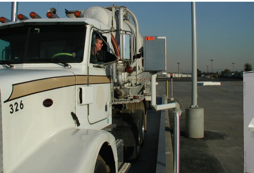
Las terminales sin supervisión permiten que los conductores ejecuten sus propias transacciones de pesaje
