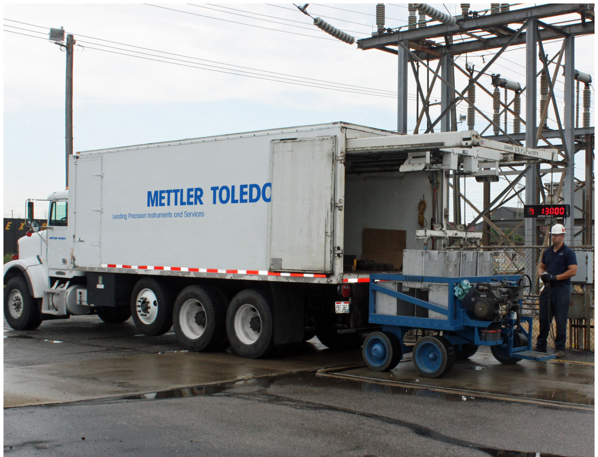
Se puede ejecutar una prueba de calibración con grandes pesas de prueba cargadas en un carro motorizado. El técnico mueve el carro a diversos puntos de la báscula con diferentes cantidades de peso para comprobar que la precisión de la báscula sea uniforme
