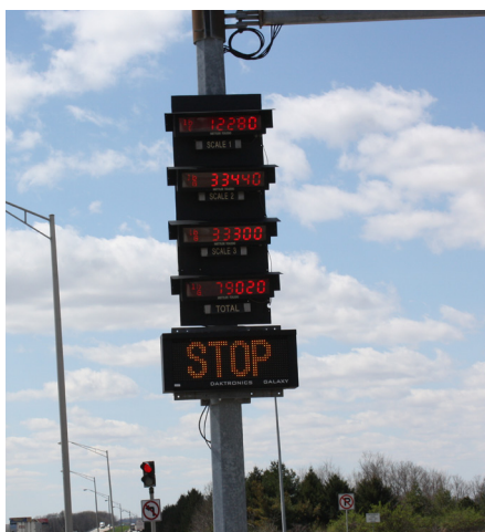
Una estación de pesaje en carretera usa varios indicadores remotos para mostrar a los conductores el peso de cada doble eje en tándem, así como el peso bruto total del camión
