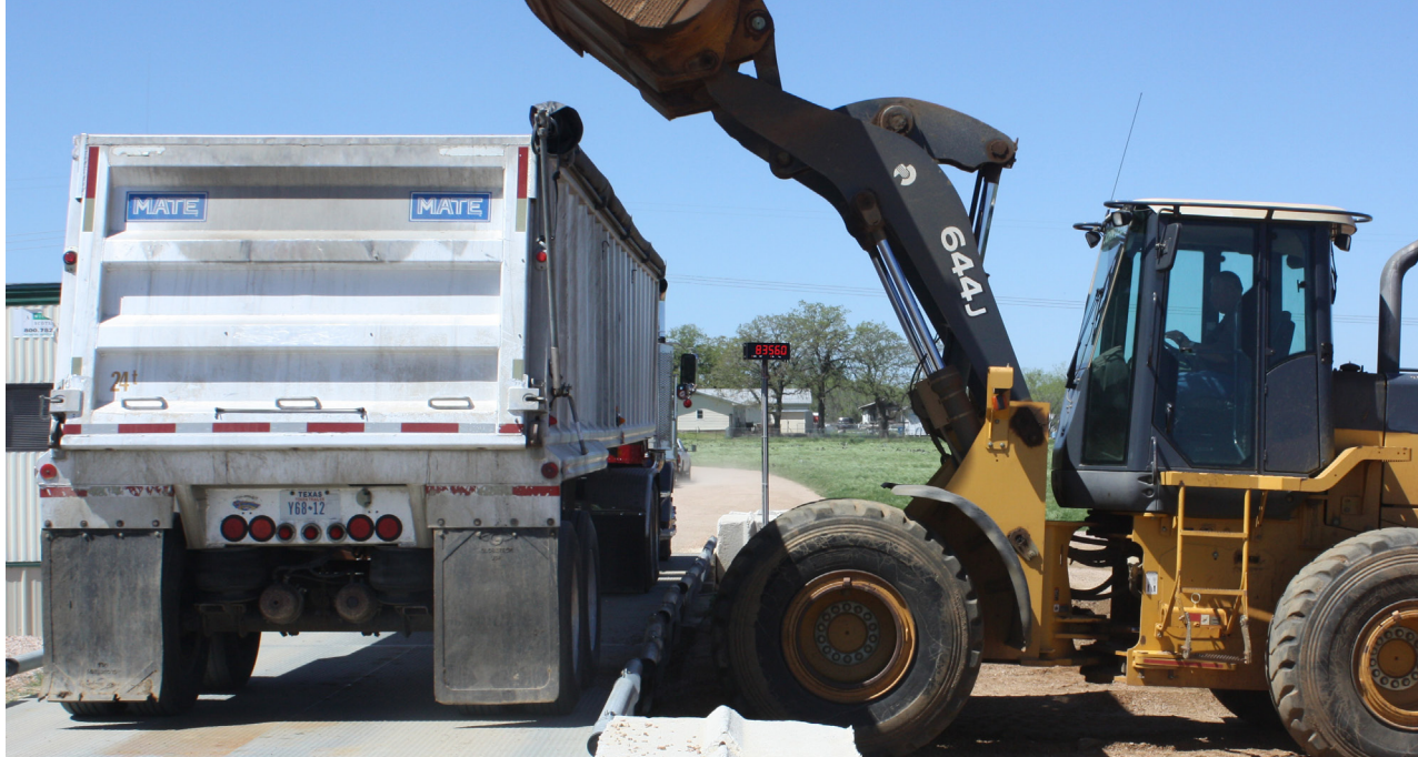
Con un indicador de peso remoto montado a la vista del operador cargador, este camión puede llenarse hasta el límite máximo de peso aprobado para la carretera
