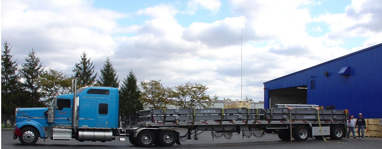
El transporte de los módulos de la plataforma de pesaje en un acoplado plano es común en algunos lugares, aunque el ancho de los módulos puede hacer necesario que el camión tenga una designación de "carga extragrande".
