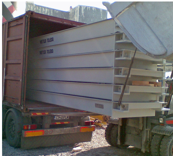
Algunos fabricantes pueden ofrecer básculas en containers para simplificar el transporte de la báscula por distancias largas o a áreas remotas
