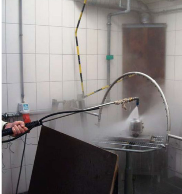
Una celda de carga POWERCELL® PDX® sometida a una prueba IP69K con rociado presurizado
