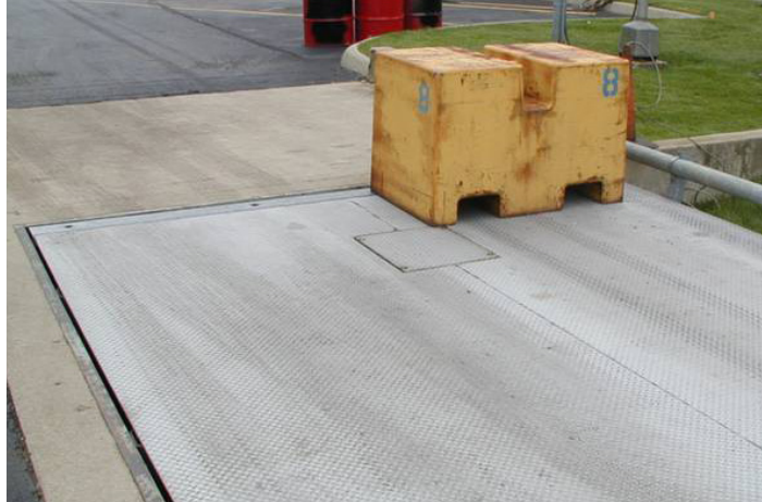
Una pesa de prueba en una esquina de la báscula
