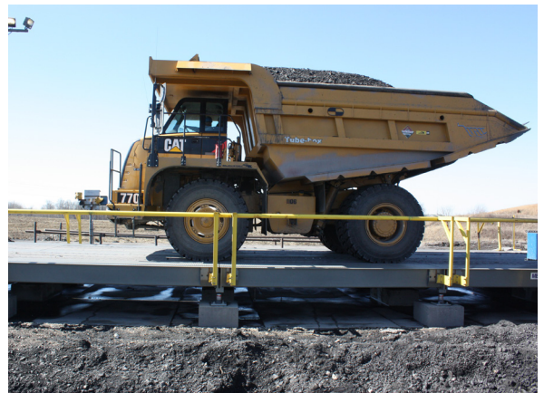
Un diseño de báscula de costados abiertos puede resultar más fácil de mantener
