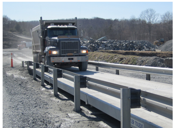
En las plantas de áridos, por ejemplo, puede resultar más fácil limpiar los productos derramados en las básculas de costados abiertos
