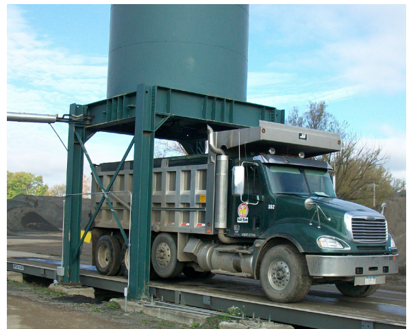
Las operaciones de llenado pueden usar una báscula para camiones como medición primaria para la dispensa
