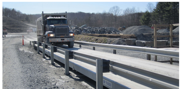
Diese eigenständigen Leitplanken werden in Längsrichtung neben der Waage im Boden verankert, um die Stabilität zu gewährleisten und zu verhindern, dass Lkws seitlich von der Waage fahren
