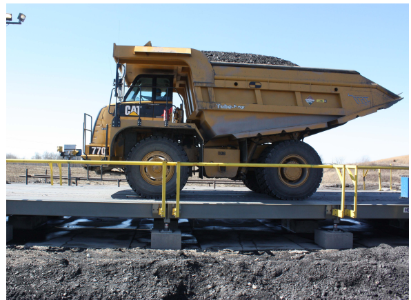
Eine Waage mit offenen Seiten lässt sich einfacher warten
