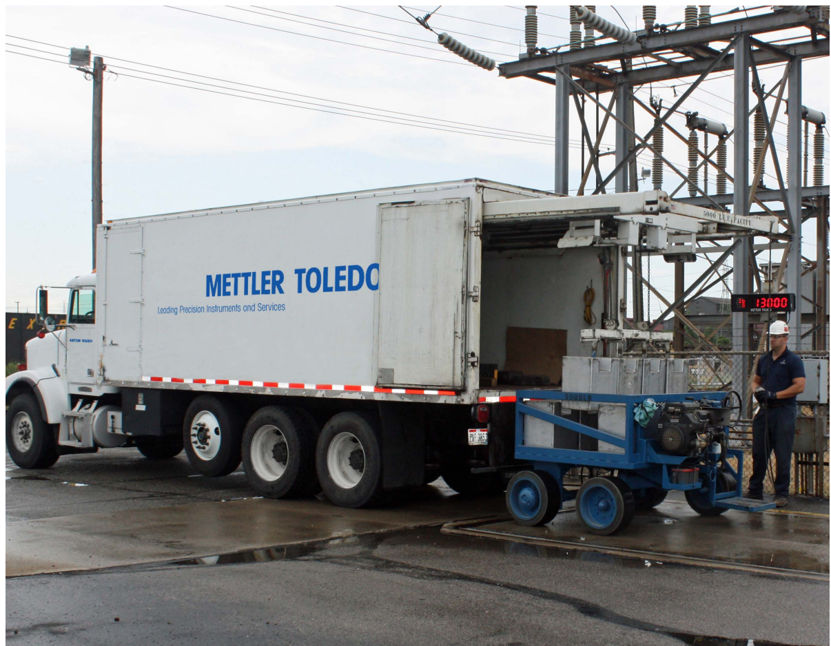
Mit grossen Prüfgewichten auf einem motorisierten Wagen kann eine Kalibrierprüfung durchgeführt werden. Der Techniker fährt den mit unterschiedlichen Prüfgewichten beladenen Wagen an verschiedene Stellen auf der Waage, um die gleichmässige Genauigkeit der Waage zu überprüfen.
