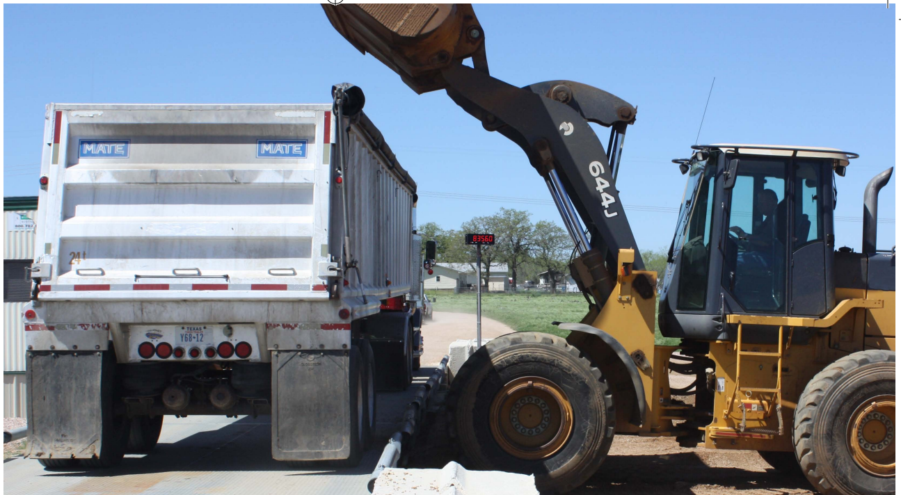
Mithilfe einer im Sichtbereich des Laderfahrers montierten externen Gewichtsanzeige kann dieser Lkw bis an die Zulassungsgrenze für den Strassenverkehr befüllt werden
