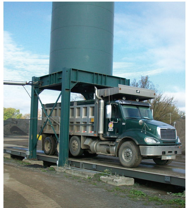
Bei Befüllvorgängen kann eine Lkw-Waage als primäre Messvorrichtung für die Produktabgabe dienen.
