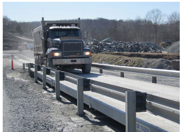
Beim Wägen von Zuschlägen lassen sich Waagen mit offenen Seiten oft leichter von verschütteten Produkten reinigen
