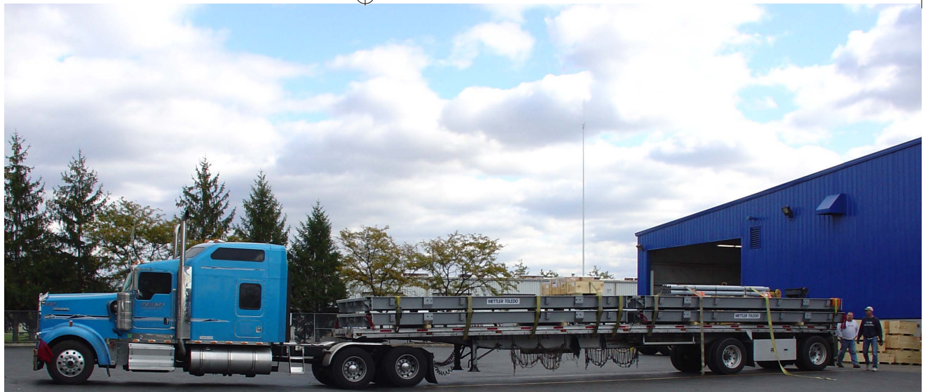
Wägebrückenmodule werden häufig auf einem Tieflader transportiert, jedoch kann die Überbreite der Module eine entsprechende Kennzeichnung des Lkws erforderlich machen
