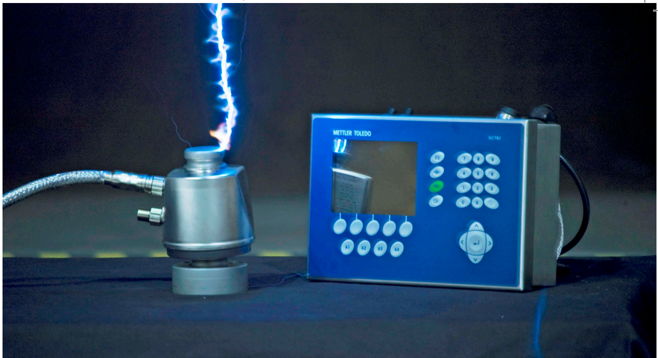
Eine POWERCELL® PDX® Wägezelle, die bei einer Blitzschutzprüfung mit einem IND780 Terminal verbunden ist
