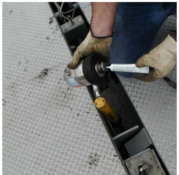
Einige Bereiche, beispielsweise die Passflächen der Wägezellen, müssen in periodischen Abständen geschmiert werden
