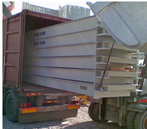
Manche Hersteller können Waagen in Containern anliefern, um den Transport über lange Strecken oder in abgelegene Gebiete zu erleichtern
