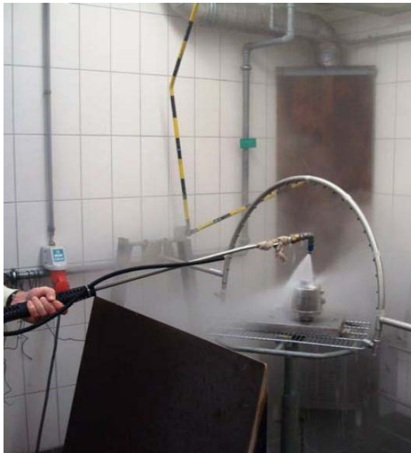
Eine POWERCELL® PDX® Wägezelle wird mit einem Wasserstrahl unter hohem Druck einer IP69K-Prüfung unterzogen
