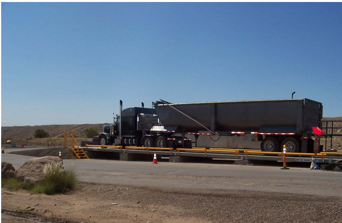
Ein sauberer Waagenbereich hilft, Wägefehler aufgrund von Schmutz- und Produktansammlungen zu vermeiden
