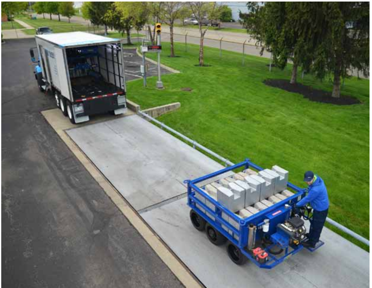
교정 검사는 전동 카트에 적재된 대형 테스트 분동을 통해 수행될 수 있습니다. 기술자는 스케일의 일관된 정확도를 테스트하기 위해 다양한 중량을 가진 분동을 사용해 스케일 위의 다양한 지점으로 카트를 이동시킵니다.
