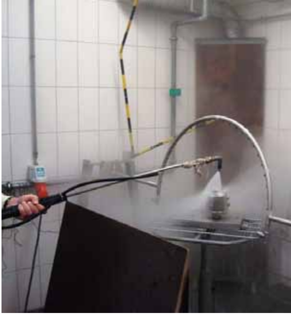
가압 스프레이로 IP69K 테스트를 하는 POWERCELL® PDX® 로드 셀
