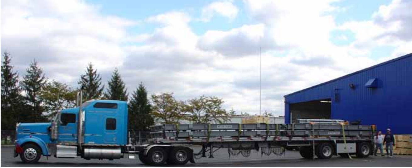
평평한 트레일러에 계량대 모듈을 운반하는 것이 일반적이지만 모듈의 너비를 고려할 때 트럭에 "대형 적재물" 표시가 필요할 수 있습니다.
