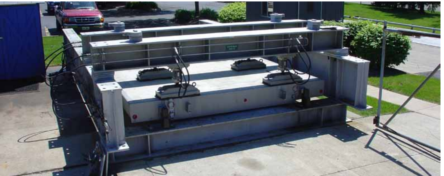
METTLER TOLEDO가 사용하는 계량대 모듈 수명 주기 테스트 기계는 스케일 위를 이동하는 트럭의 힘을 재현합니다.
