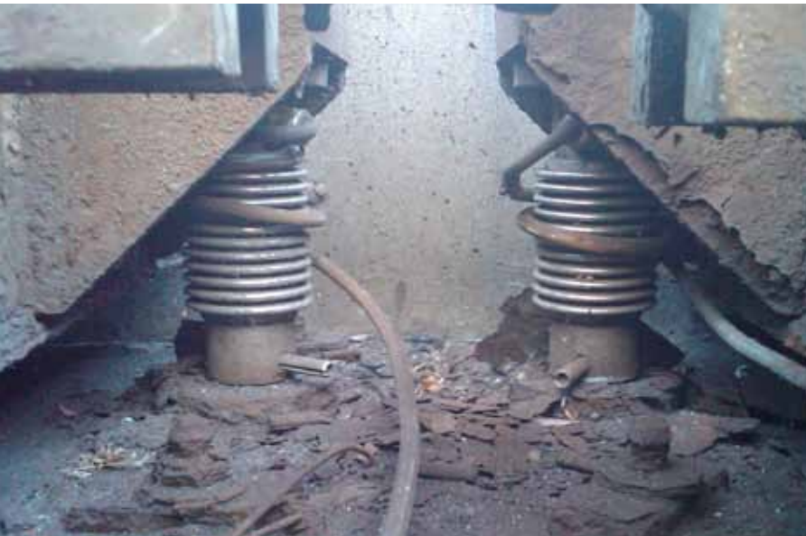
압축 형태 로드 셀에는 부적합한 회전 방지 기능이 있어 결국 케이블이 로드 셀과 브레이크를 감쌀 수 있습니다.
