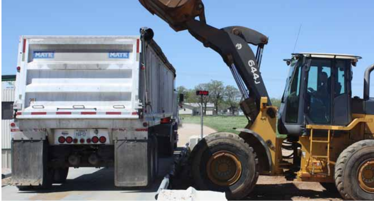
적재기 작업자의 관점에서 장착된 원격 중량 디스플레이를 통해 최대 도로 중량 제한에 이를 때까지 이 트럭에 충전할 수 있음
