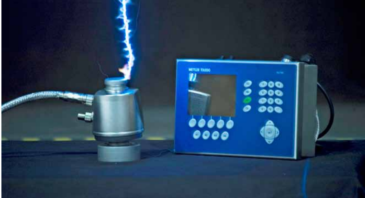
낙뢰 테스트 중인 IND780 터미널에 연결된 POWERCELL® PDX® 로드 셀
