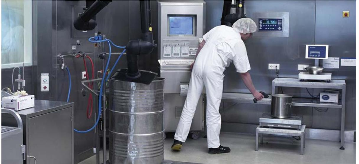
圖 8：以離線方式稱量徒手添加的材料
