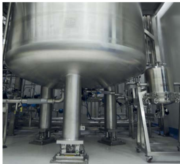
Sección inferior del reactor montado en módulos de pesaje de compresión flexibles
