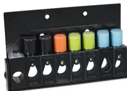
CertiRef内部 密封的液体认证标准品比色皿和固体认证中性密度滤光片
