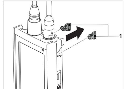
2 将仪表底座稳定装置 (1) 推入仪表的凹槽 (2) 中。
