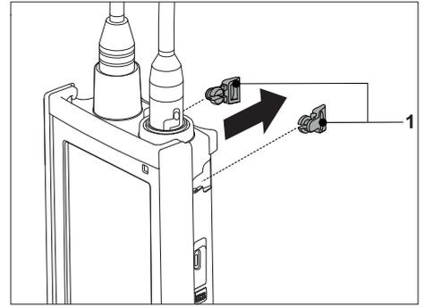
2 将电极支架 (1) 推入仪表上的凹槽 (2) 中。
