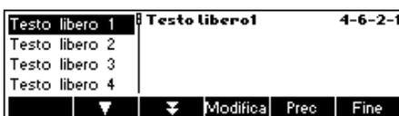
Il testo libero consente di controllare l'output di diverse stampanti e di generare stampe personalizzate. Può contenere variabili che è possibile definire, e che in fase di stampa verranno sostituiti dai loro valori corrispondenti. È anche possibile inserire codici di controllo per controllare la stampante collegata. Qualunque stampante può essere controllata tramite questa operazione.
