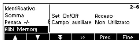
Premere "on" o "off" per attivare/disattivare la memoria alibi. Oltre ai campi obbligatori può essere configurato un ulteriore campo per i dati supplementari. Possono essere memorizzate un totale di 150.000 pesate.
