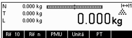
Viene attivato un test del display (Capitolo 1.4). Quando compare la schermata di peso, il terminale è pronto per essere utilizzata e si azzer automaticamente.
