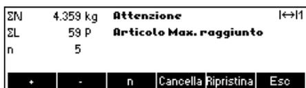
Se è stato definito un valore **Max di "n"**, sarà possibile sommare solo un numero di lotti pari al valore impostato. Una volta che il numero di lotti sommati raggiunge il valore di Max n, verrà visualizzato un messaggio che indica che è stato raggiunto il numero massimo di articoli.
