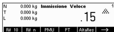
Quando si è in modalità standby, utilizzare il tastierino numerico per immettere il **peso di tara conosciuto** nell'unità di misura corrente.
