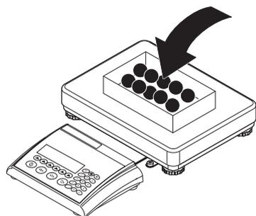
...porre 10 pezzi di materiale da pesare per determinare il peso di referimento.
