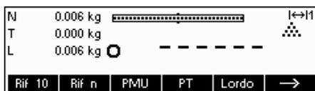
IND465 calcola il peso medio unitario come nel Capitolo 4.1.1 ma ha stabilito che la percentuale di precisione per il peso di riferimento è inferiore al valore impostato come peso minimo del campione.
