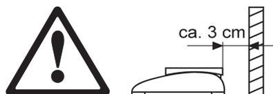
Qualora il **cavo di alimentazione** fosse danneggiato, non utilizzare più la bilancia. Si consiglia di controllare regolarmente il cavo e di assicurarsi che nella parte posteriore della bilancia rimanga sempre uno spazio libero di circa 3 cm, in modo da impedire che il cavo si pieghi eccessivamente.
