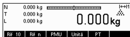
Non appena il terminale riceve corrente, si attiva un test del display dove vengono visualizzati in breve tutti i segmenti e quindi la versione del software. Quando lo zero decimale compare sul display, il terminale è pronto per essere utilizzata.
