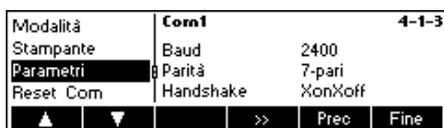
Tornare indietro nel menu premendo «Prec.» e selezionare "Parametri". Ora è possibile modificare le impostazioni di Baud ("Baud"), di parità e handshake. Consultare il manuale di istruzioni della stampante e verificare la correttezza dei dati. Nell'esempio, il valore dell'immagine a sinistra da visualizzare è accesa.
