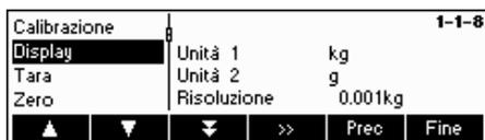
Premere «**>>**» e selezionare ad esempio "Unità 1", poi selezionare «**Modifica**» per cambiare l'unità di misura.
