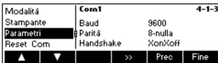
Sullo schermo vengono visualizzate le impostazioni correnti di velocità Baud, Parità e Handshake. Premere «>>>» e ...
