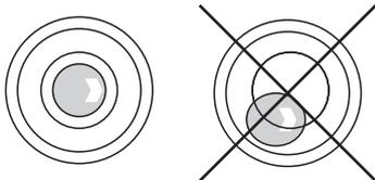
Ruotare i piedini regolabili in modo che la bilancia sia in posizione orizzontale. Se c'è una livella a bolla d'aria, la bolla deve posizionarsi nel cerchio interno.
