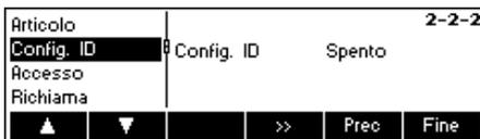
Struttura ID - Se questa funzione è "Accesa", è possibile richiamare direttamente gli IDs premendo il tasto della banca dati.
