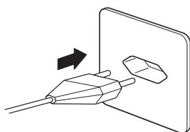
Prima di collegare la spina di alimentazione o l'adattatore AC (versione AccuPac), verificare che la tensione indicata sulla targhetta di identificazione corrisponda alla tensione di rete locale.
