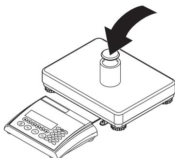
Una volta selezionato il peso per la calibrazione, posizionare il carico corrispondente sul piatto di pesata e poi premere il tasto «**OK**».
