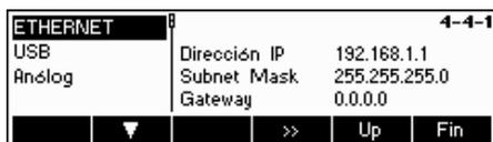
Seleccione ETHERNET y pulse «>>» para introducir los ajustes ETHERNET.
