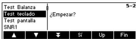
Para comprobar que todas las teclas funcionan correctamente, pulse «**Sí**» para empezar la prueba del teclado.
