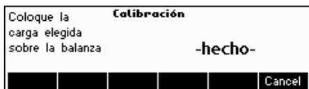
La calibración se ha realizado. Continúe con otras funciones o pulse «**Fin**» y confírmelo pulsando la tecla «**Sí**» para guardar los cambios.
