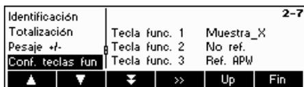
Pulse «**Editar**» para ir al menú de ajustes de configuración de las teclas de función.
