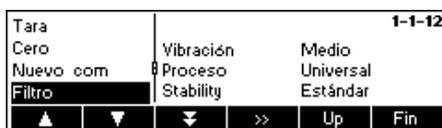
Pulse la tecla «**»»**» para ir al menú de ajustes de proceso y vibración. Ajustes posibles:
