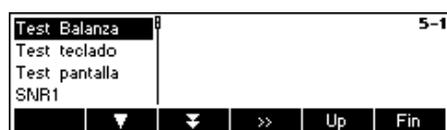
– Pulse «>>>» para ir a el test de la balanza.
