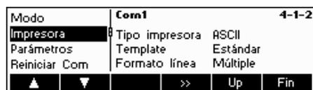
Los ajustes actuales de la impresora aparecen en el lado derecho de la pantalla. Pulse «>>>» para ir al menú de ajustes de la impresora.
