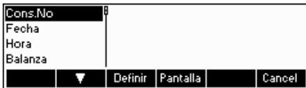
Pulse la tecla «**Buscar**» para localizar la máscara de búsqueda de la memoria alibi. Con esta función puede definir el criterio de búsqueda que servirá de base para buscar entradas. Pulse «**Cambiar**» y seleccione el criterio de búsqueda deseado. Debe seguir dos pasos para introducir el criterio de búsqueda: primero debe introducir "desde margen", después "hacia margen". El criterio de búsqueda "Báscula" y "Campo auxiliar" no le ofrece ninguna información referente a "De/Para".
