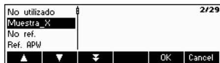
Utilice las teclas «▲» y «▼» para seleccionar la función que desea designar y pulse «OK».
