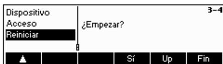
Pulse «**Si**» para restablecer los ajustes del terminal. '¿EMPEZAR?' aparecerá en la pantalla, pulse «**Si**» para confirmar. Los ajustes del terminal ya están restablecidos según sus valores originales.
