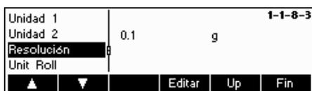
Para cambiar los ajustes de resolución de la báscula, seleccione "Resolución" (esta función no está disponible en todos los modelos).
