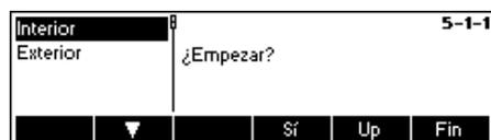
Elegir la pesa de calibración interno o externo para el test de la balanza
