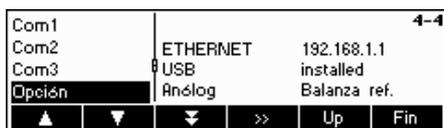
Seleccione USB y pulse «>>» para introducir los ajustes ETHERNET.
