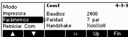
Retroceda un paso en el menú pulsando «Atrás/Back» y seleccione "Parámetros". Ahora puede cambiar los ajustes de los baudios, paridad y handshake. Consulte el manual de usuario de su impresora y verifique los datos. En nuestro ejemplo está conectado el valor de la imagen izquierda que se hará visible.
