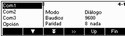
Seleccione el puerto COM donde desea conectar su impresora en el menú "Configuración de visualización" en la sección "COMUNICACIONES". En nuestro ejemplo, hemos utilizado el puerto COM 1. Pulse «>>».
