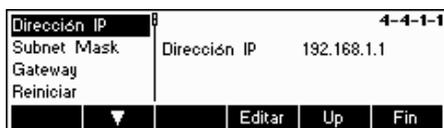
Seleccione "Dirección IP", "Subnet Mask" o "Gateway" y pulse «Editar» para optar por el ajuste deseado. Seleccione "Reiniciar" para restablecer los valores por defecto.
