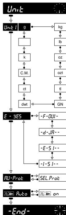
El registro de configuración con NetEasy-M sólo se diferencia del registro de configuración de la balanza con casete de programa estándar en el sector –Unit–. Con NetEasy-M se puede seleccionar en el sector –Unit– lo siguiente:
