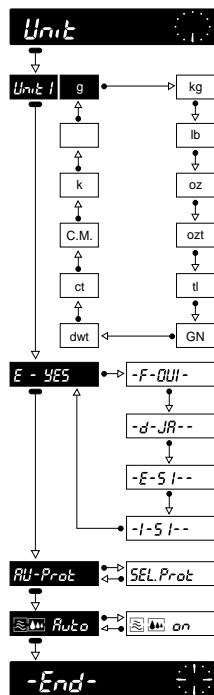
Il registro configurazioni con NetEasy-M si differenzia dal registro configurazioni della bilancia con la normale cassetta di programma soltanto nel settore –Unit–. Con la cassetta NetEasy-M nel settore –Unit– è possibile selezionare le seguenti opzioni:
