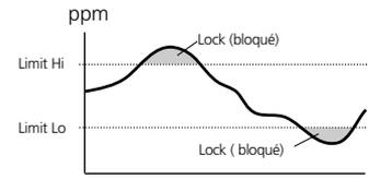
L'appareil ne démarre un intervalle de nettoyage que si la valeur mesurée se situe dans les limites tolérées (Limit-Lo/Limit-Hi). (Réglages des valeurs limites: pages 49, 51)
