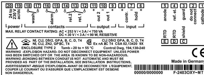
Fig. : Correspondance des bornes Transmetteur O<sub>2</sub> 4100ppb
