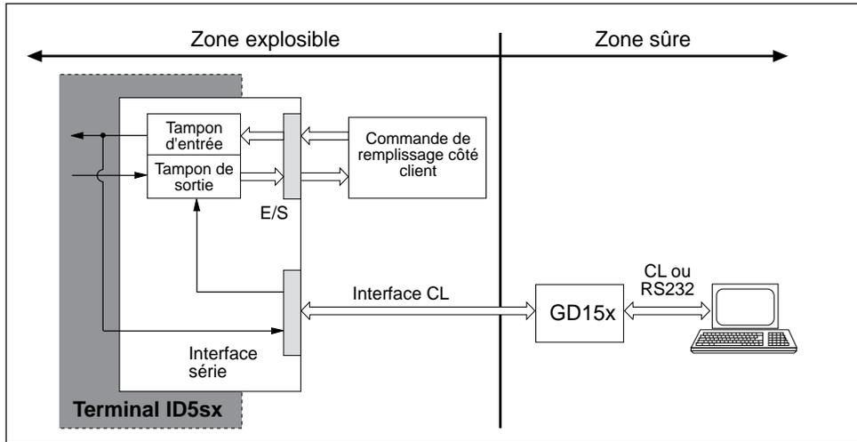
Les entrées et sorties peuvent être lues ou être mises à "1" ou "0" via des tampons d'entrée et de sortie.
