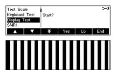
In order to check if the screen is functioning properly, press «Yes» and...
