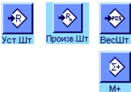
Определите массу эталонного образца одним из доступных методов (с фиксированным количеством образцов, с произвольным количеством образцов или с непосредственным вводом, см. раздел 11.4.1).
