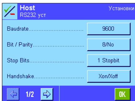
**Внимание!** Для правильной распечатки специальных символов (например, "°C") на принтерах METTLER TOLEDO в настройках параметров интерфейса **весов и принтера** необходимо установить **8 бит данных**.
