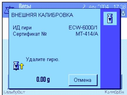
После того как соответствующая гири будет установлена на весы, процедура калибровки выполняется автоматически. По завершении регулировки система предложит удалить гирю. Снимите калибровочную гирю с чашки весов.
