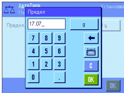
После включения (“Вкл”) функции “**АвтоТара**” нажмите клавишу, задать критерии автоматического тарирования:
