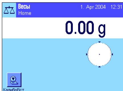
**Включение весов:** нажмите и отпустите клавишу «**On/Off**». Сразу после включения в память весов загружаются пользовательский профиль и режим взвешивания, с которыми весы работали перед выключением. Название профиля и индикатор режима отображаются в левом верхнем углу экрана.
