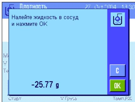
После тарирования веса грузика система предложит залить в емкость жидкость, плотность которой необходимо определить. При взвешивании под весами установите емкость с жидкостью под подвесом. При использовании дополнительного комплекта для определения плотности следуйте указаниям соответствующего руководства.
