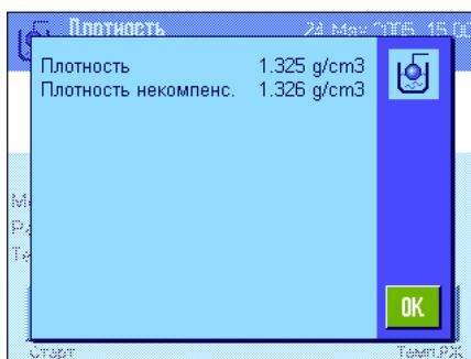
После этого весы вычислят плотность образца и выведут результат на дисплей (в зависимости от выбранных установок выводится скорректированное и/или нескорректированное значение, см. раздел 13.3.5).
