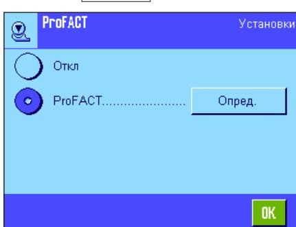
В этом меню можно задать параметры автоматической калибровки с использованием **встроенной** калибровочной гири. Функция ProFACT (**P**rofessional **F**ully **A**utomatic **C**alibration **T**echnology – полностью автоматическая профессиональная технология калибровки) обеспечивает автоматическую калибровку весов по заданным временным и/или температурным критериям.
