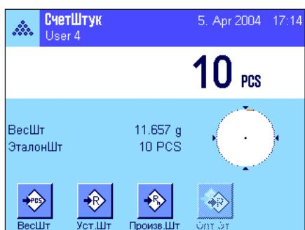
Определите массу эталонного образца одним из доступных методов (с фиксированным количеством образцов или с произвольным количеством образцов, см. раздел 11.4.1). В примере, показанном на рисунке слева, количество эталонных образцов равно 10.
