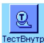
Нажатием этой функциональной клавиши можно запустить процедуру тестирования с использованием встроенной гири.
