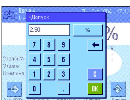
Для задания допусков используйте функциональные клавиши "**+Допуск**" и "**-Допуск**". Окно ввода допуска аналогично окну ввода номинального значения. По умолчанию установлены значения допусков 2.5 %. Допуски могут быть относительными (в процентах) или абсолютными (в любых единицах массы, например, "g"). Для сохранения заданного допуска нажмите "**OK**". Результаты, выходящие за пределы допусков, отмечаются в протоколе символом ">T" или "<T".
