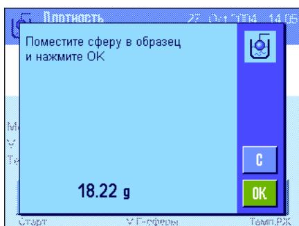
После тарирования образца система предложит погрузить эталонную сферу в образец.
