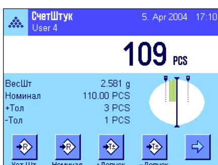
После ввода номинального значения массы и допусков на дисплее появляется специальный графический индикатор (“СмартТрек”) с маркерами границ допусков, упрощающий взвешивание до заданного номинального значения. С его помощью можно вначале грубо взвесить образцы по нижней границе допуска, а затем, при необходимости, довести количество образцов до номинала.
