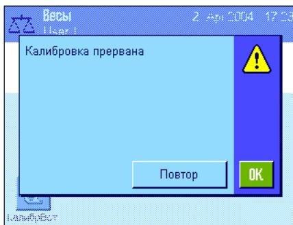
**Калибровка прервана.** Это сообщение выводится в том случае, когда калибровка прерывается пользователем. Для того чтобы повторить процедуру калибровки, нажмите клавишу “**Повтор**”; чтобы вернуться в текущий режим взвешивания, нажмите клавишу “**OK**”.
