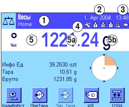
Дисплей разделен на отдельные области (на рисунке показан вид дисплея с информационными полями и индикатором "СмартТрек").
