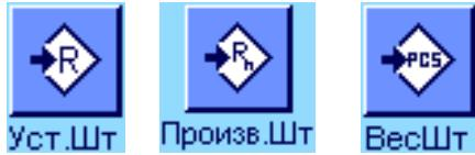
Для простого счета штук необходимо включить хотя бы одну из трех функциональных клавиш, показанных на рисунке слева (см. раздел 11.3.3), которые используются для определения массы эталонного образца.
