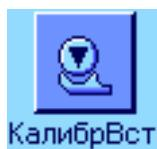
При нажатии этой функциональной клавиши запускается процедура калибровки весов с использованием встроенной калибровочной гири. Эту процедуру можно выполнить в любой момент.
