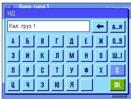
**Примечание:** калибровочную гирю можно выбрать из списка, который выводится на дисплей в процессе выполнения процедуры регулировки (раздел 8.4.3). Рекомендуется использовать обозначения длиной не более 15 символов, чтобы они полностью помещались в строках списка.
