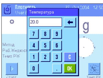
Если в качестве **вспомогательной жидкости используется вода или этанол**, введите **температуру** жидкости с помощью функциональной клавиши “**Темп. РЖ**”.(таблицы плотности этих двух жидкостей в диапазоне температур от 10 °C до 30 °C хранятся в памяти весов; см. также разделы 13.7 и 13.8). На рисунке слева показано соответствующее окно ввода (температура вводится в градусах Цельсия с точностью до одной десятой).
