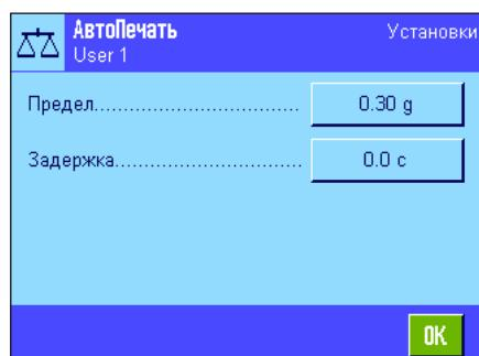
После включения функции автопечати (“АвтоПечать” – “Вкл”) нажмите клавишу “Опред.”, чтобы задать критерии автоматического вывода:
