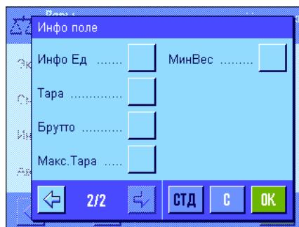
В этом меню можно выбрать информационные поля, которые будут выводиться на экран. В режиме взвешивания будут отображаться те информационные поля, которым соответствуют пронумерованные клавиши. Номера определяют расположение информационных полей на дисплее. **Внимание!** На дисплее помещаются только 4 информационных
