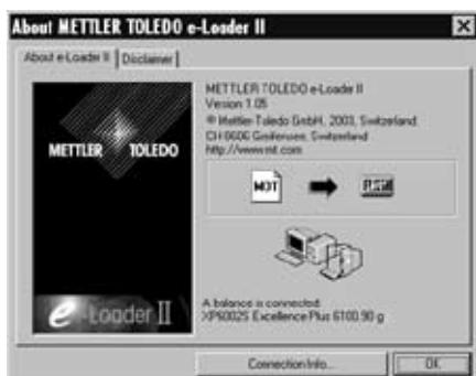
В меню “Help” (справка) проверьте наличие связи с весами (сообщение об установлении соединения с весами выводится в нижней части окна программы e-Loader II, см. рисунок слева).
