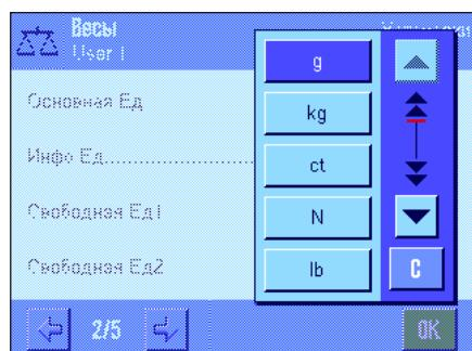
Основная и дополнительная единицы выбираются из одного и того же списка (см. также таблицу пересчета единиц в разделе 21.1). Количество доступных единиц измерения зависит от модели весов. **Примечание:** для просмотра всего списка единиц измерения массы используйте клавиши со стрелками в правой части окна.
