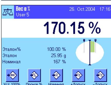
После ввода номинального значения массы и допусков на дисплее появляется специальный графический индикатор ("СмартТрек") с маркерами границ допусков, упрощающий взвешивание до заданной номинальной массы. С его помощью можно вначале грубо взвесить образец по нижней границе допуска, а затем, при необходимости, довести массу образца до номинала.
