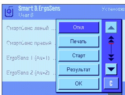
Установки **“Старт”** и **“Результат”** позволяют эмулировать одноименные функциональные клавиши. **“OK”** эмулирует нажатие одноименной клавиши в диалоговых окнах режима определения плотности (но не в меню) для подтверждения ввода или выполнения операций.
