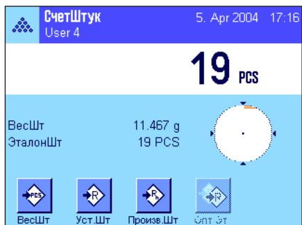
Продолжайте подсчет образцов, добавляя образцы на весы. Для оптимизации массы эталонного образца нажмите клавишу “**Опт.Эт.**”. Новое значение массы эталонного образца будет рассчитано исходя из текущего количества образцов, находящихся на весах.
