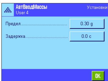
После включения функции (“Вкл”) нажмите клавишу “**Опред.**”, чтобы задать критерии автоматической записи измеренных значений в память.
