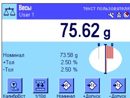
После ввода номинального значения массы и допусков на дисплее появляется специальный графический индикатор ("СмартТрек") с маркерами границ допусков, упрощающий взвешивание до заданного номинального значения. С его помощью можно вначале грубо взвесить образцы по нижней границе допуска, а затем, при необходимости, довести массу каждого образца до номинала.
