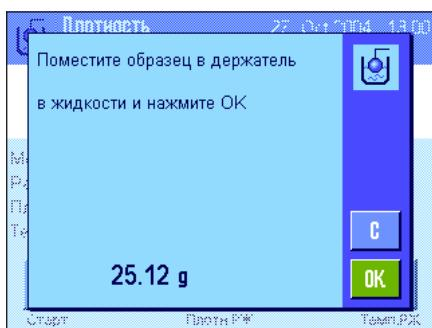
Результат взвешивания будет сохранен в памяти весов, после чего система предложит погрузить образец во вспомогательную жидкость.
