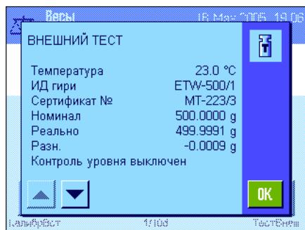
В случае успешного завершения тестирования выводится окно, показанное на рисунке слева. Если к весам подключен принтер, на печать выводится протокол тестирования согласно системным параметрам, заданным для протоколирования тестирования (см. раздел 6.3.7). Пример протокола приведен в разделе 8.4.6.
