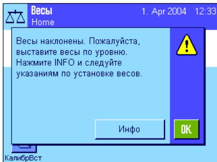
При отклонении весов от горизонтальной плоскости датчик выдает звуковой сигнал и выводит на дисплей сообщение, показанное на рисунке слева. Кроме того, в правом верхнем углу дисплея (под часами) появляется соответствующий индикатор состояния.
