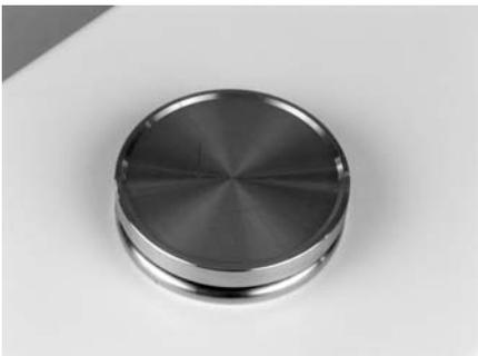
Setzen Sie den Konus der Waagschale in die Waagschalen-Aufnahme ein. Dabei braucht keine bestimmte Position beachtet zu werden, die Standard-Waagschale ist frei drehbar.
