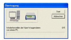
Beachten Sie, dass während des 'Wiederherstellen' Vorgangs die Prozessgeschwindigkeit, abhängig von der Anzahl der Artikel, die bereits in der Viper Smart Count Waage gespeichert sind, variiert. Dies beruht auf der Tatsache, dass die Viper Smart Count einen Vergleichstest mit eingehenden Artikeln und jenen die bereits in der Waage gespeichert sind durchführt, um zu prüfen, ob die Artikel in der Tat eindeutig benannt sind.
