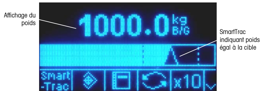
Figure 2-12 : Transfert des matériaux SmartTrac™ petite taille
