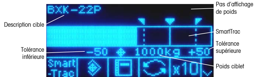
Figure 2-14 : Transfert des matériaux SmartTrac™ grande taille
