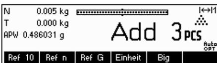
BBA462 / BBK462 berechnet die zusätzliche Anzahl an Teilen, die auf die Waagschale aufgebracht werden muss, um die gewünschte prozentuale Genauigkeit zu erzielen.
