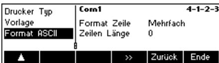
Wurde als Drucker Typ „ASCII“ gewählt, erscheint zusätzlich der Menüpunkt „Format ASCII“. Darin können die Einstellungen für das Zeilenformat (Format Zeile) und für die Zeilenlänge von ASCII- Druckern definiert werden. Dabei haben die möglichen Einstellungen folgende Bedeutung:
