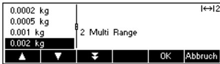
Wählen Sie mit den Tasten «▲» und «▼» die gewünschte Auflösung und drücken Sie «OK». Bei Mehrbereichswaagen steht die Auflösung 'd1' zweimal (modellabhängig), als Single Range (Einbereich) oder als Multi Range (Mehrbereich) zur Verfügung (das Symbol befindet sich in der Ecke oben rechts).
