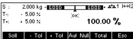
Mithilfe der Anzeige kann auf einfache Art und Weise nachgeprüft werden, ob sich das Gewicht des Wägeguts innerhalb der definierten Toleranzen befindet. Diese können auch unterschiedlichen Formats (Rel., Abs., %), sowie asymmetrisch sein.
