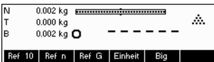
BBA462 / BBK462 berechnet das mittlere Stückgewicht wie in Kapitel 4.1.1 beschrieben, ermittelt jedoch, dass die prozentuale Genauigkeit des Referenzgewichts unter dem für das Mindestreferenzgewicht eingestellten Wert liegt.
