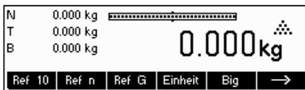
**Hinweis:** «T Eing.» ist standardmäßig nicht definiert, da der Tara – Vorabzug auch über den Kurzeingabemodus eingegeben werden kann (siehe Kapitel 3.1). Diese Funktionstaste muss separat im Vision Setup definiert werden. Zur Definition der Funktionstaste «T Eing.» siehe Kapitel 5.5.7. Unter Kapitel 5.3.2 finden Sie eine Übersicht über alle einstellbaren Funktionstasten. Drücken Sie «→», um weitere Funktionstasten anzuzeigen und «←», um auf die erste Seite der Funktionstasten zurückzukehren.
