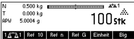
**Referenzwaage** Die Zweitwaage wird ausschließlich zur Referenzgewichtsbestimmung eingesetzt. Das mittlere Stückgewicht wird, ungeachtet der aktiven Waage, aus dem auf die Zweitwaage aufgebrachten Gewicht errechnet. Dies ist der Fall, wenn die Zweitwaage (z. B. eine Analysewaage) eine feinere Auflösung als die BBA462 / BBK462 besitzt, um so ein genaueres Stückgewicht zu erhalten.
