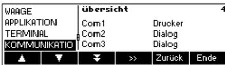
Gehen Sie ins Menü KOMMUNIKATION («**>>>**») und wählen Sie einen COM-Port, die Optionseinstellungen, die Einstellungen für die PS/2 Schnittstelle oder die Einstellungen für den benutzerdefinierten Ausdruck an.
