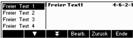
Die **freien Texte** ermöglichen die Ansteuerung unterschiedlicher Drucker und die Generierung benutzerdefinierter Ausdrücke. Es besteht die Möglichkeit Variablen zu definieren, die beim Ausdruck durch deren entsprechenden Wert ersetzt werden. Ebenfalls können Steuersequenzen eingegeben werden, um einen angeschlossenen Drucker steuern zu können. Somit kann jeder beliebige Drucker angesteuert werden.
