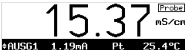
Im Meßmodus weist die Anzeige "Probe" rechts oben im Display daraufhin, daß ein Probenwert für die Kalibrierung gespeichert wurde. Das Gerät erwartet die Eingabe des Laborwertes, mißt aber mit der alten Zellkonstanten weiter.
