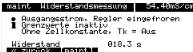
Die Bedienerführung wird durch eine 7-zeilige Klartext-Anzeige mit Informationstexten unterstützt. Während der Bedienung bleiben der aktuelle Meßwert und aktuelle Statusmeldungen immer sichtbar.
