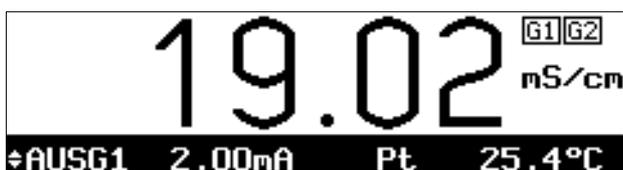
Wenn die parametrisierten **Grenzwerte**, z. B. beim Leitfähigkeits-Meßwert, über- oder unterschritten werden, erscheint rechts oben im Display "G1" und/oder "G2".
