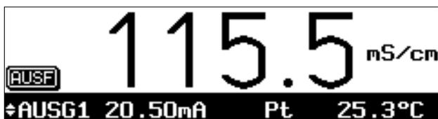
Wenn die parametrisierten Grenzen, z. B. beim Leitfähigkeits-Meßwert, für die **Warnungs-Meldung** ("Wartungsbedarf") oder die **Ausfall-Meldung** überschritten werden, erscheint links unten im Display "WARN" oder "AUSF".
