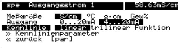
Sie können für den Stromausgang drei Ausgangskennlinien parametrieren:
