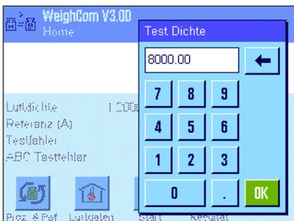
Falls Sie bei der Prozessdefinition den Parameter "Luftauftriebskorrektur" auf "Ja" eingestellt haben, werden Sie jetzt aufgefordert die Dichte des Testgewichts in  $\text{kg/m}^3$  einzugeben. Bestätigen Sie Ihre Eingabe mit "**OK**".
