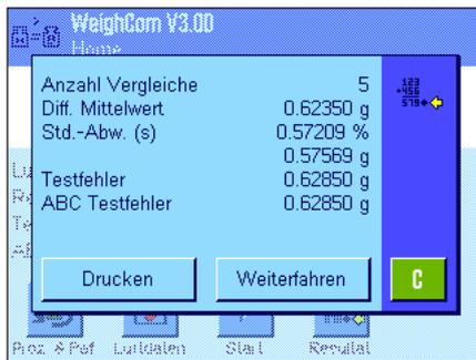
Am Ende der Vergleichsmessungen wird das Ergebnis auf der Anzeige eingeblendet. Das Ergebnis-Fenster enthält die folgenden Angaben:
