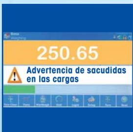
El sistema POWERCELL controla los eventos que se producen en cada una de las células de carga, por ejemplo, sobrecarga, sacudidas de las cargas y deriva nula. Esto proporciona una visibilidad del estado del sistema y solicita que se lleve a cabo una acción antes de que el sistema se apague o genere resultados de mediciones incorrectos.
