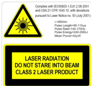
Il CSN950MH è dotato di diodo laser (rosso) visibile Classe 2 a lunghezza d'onda 660 nm. L'etichetta di avvertenza sui prodotti laser all'esterno dell'unità riporta informazioni sull'emissione laser.
