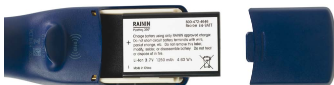
Figure 4 : Installation de la batterie principale
