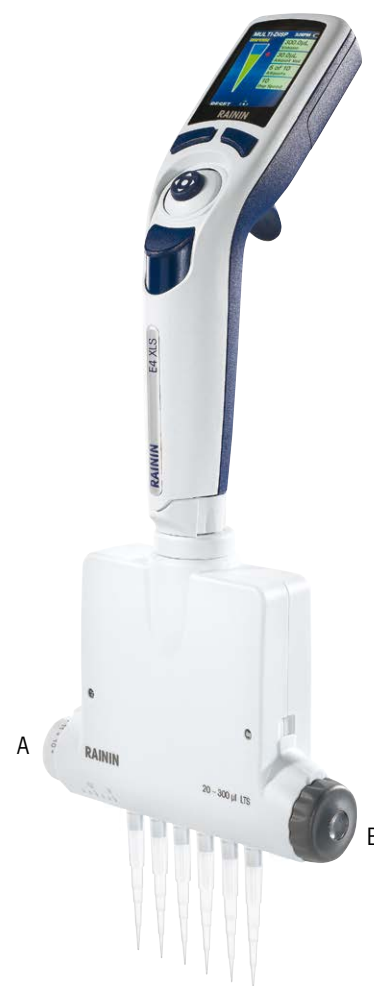
Figure 36 : Pipette E4 XLS à écartement variable A : RÉGLAGE DE L'ESPACEMENT B : LIMITEUR
