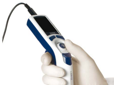
Figure 5 : Utilisation de la pipette E4 XLS avec le cordon d'alimentation branché
