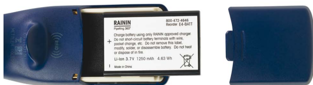
Figure 26 : Remplacement de la batterie
