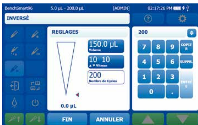
Figure 3-42 : remise à 200 du compteur de cycles
