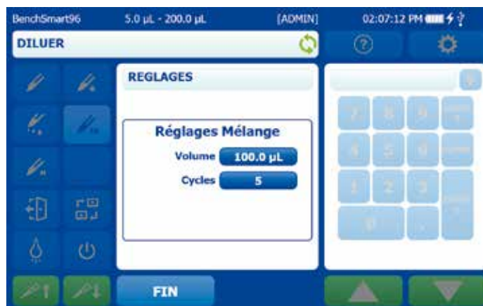
Figure 3-32 : réglage du volume de mélange et du nombre de cycles de mélange
