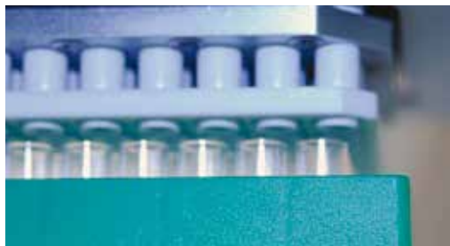
Figure A-2 : embouts non alignés (vue agrandie)
