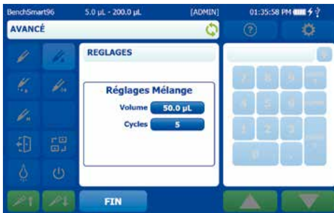
Figure 3-8 : réglage du volume de mélange et du nombre de cycles de mélange
