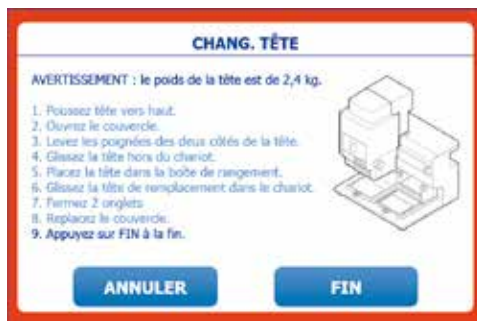
Figure 1-22 : Séquence de chargement de la tête
