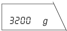
Wird der Feinbereich in der Anzeige überschritten, wechselt die Waagenanzeige automatisch zur geringeren Ablesbarkeit.
