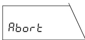
Falls die Justierung (Kalibrierung) nicht ordnungsgemäss durchgeführt werden kann (z.B. infolge von Erschütterungen), bricht die Waage den Justiervorgang ab und in der Anzeige erscheint "Abort". Drücken Sie die Taste «**C**», um diese Meldung zu löschen und starten Sie den Justiervorgang erneut.
