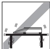
Posición fija, sin vibraciones y lo más horizontal posible. La base ha de poder soportar de forma segura el peso de la balanza totalmente cargada.
