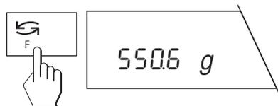
Con la tecla « $\rightarrow$ » puede Vd. cambiar en cualquier momento entre indicación de cantidad, unidad de pesada 1 y unidad de pesada 2.
