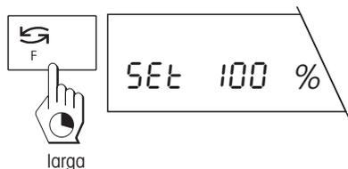
Su balanza necesita un peso de referencia que corresponda al 100%. Pulse la tecla «F» y téngala pulsada hasta que se le pida cargar el peso de referencia. Cargue ahora el peso de referencia.
