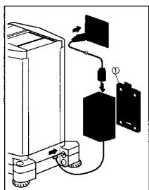
如果您想用支架来固定适配器，则请将支架用螺丝固定住，使其平稳(如固定在墙上或工作台上)，再将适配器放在支架上。
