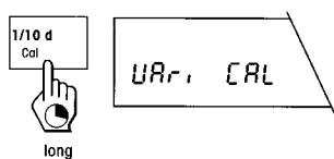
按住《cal》键开始校准操作。天平简要地提示您校准需要一个外部砝码。
