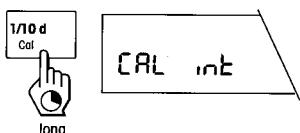
校准过程是通过持续按住《Cal》键来完成的。天平简单地显示内置砝码校准执行情况。
