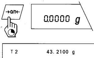
短促地按动《→ 0/T ←》键。天平现在给新增的容器去皮。如果您的天平与打印机相连，新增容器的去皮重量会被打印出来。您现在可以称取新增成份的重量了。
