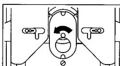
拧松吊架盖的螺丝。螺丝松动的程度以您可转动吊架盖为限。
