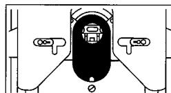
把吊架盖转动 180°。让吊架盖上的孔对准天平底座开口。
