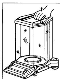
打开顶部防风罩，并用手把持住后部的提携框，将天平安置好或手扶住天平下部的显示屏后部护罩来搬动它。
