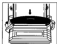
将称量底盘插入称量室内(直的一端在前，凸出部分向上)，并向下按以定位。
