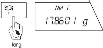
Füllen Sie nun die Komponente in den Behälter ein, bis das gewünschte Nettototalgewicht erreicht ist.
