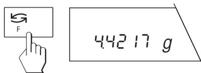
Mit der Taste «G» können Sie jederzeit die Anzeige umschalten zwischen der Prozentanzeige, der Wägeinheit 1 und der Wägeinheit 2.
