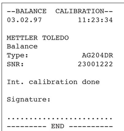
Falls Ihre Waage mit einem Drucker verbunden ist, wird die Justierung (Kalibrierung) automatisch GLP konform protokolliert. Das nebenstehende Protokoll ist ein Muster, ausgedruckt mit dem Drucker METTLER TOLEDO LC-P45. Je nach angeschlossenem Drucker kann der Ausdruck vom gezeigten Beispiel etwas abweichen.
