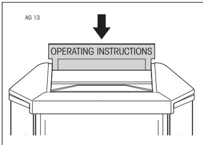
Setzen Sie den Schieber wieder in seine Führung an der Waage ein und schieben Sie ihn ganz nach unten.
