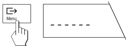
Drücken Sie anschliessend kurz die Taste «Menu». Solange die horizontalen Striche angezeigt werden, berechnet Ihre Waage das Referenzgewicht.
