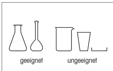
Verwenden Sie stets das kleinstmögliche Wägegefäss, da der Fehler mit zunehmender Behältergrösse tendenziell grösser wird. Zudem sollten Sie Wägegefässe mit möglichst engem Hals und einem Deckel verwenden.
