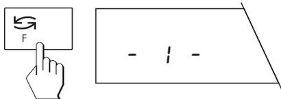
Drücken Sie anschliessend kurz die Taste «F». In der Anzeige erscheint kurz "- 1 -", um das Einwägen der ersten Komponente zu bestätigen.
