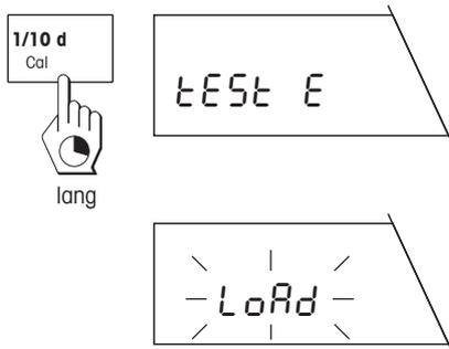
Lösen Sie den Prüfvorgang durch langes Drücken der Taste «Cal» aus. Die Waage bestätigt kurz, dass die Überprüfung mit einem externen Gewicht erfolgt.
