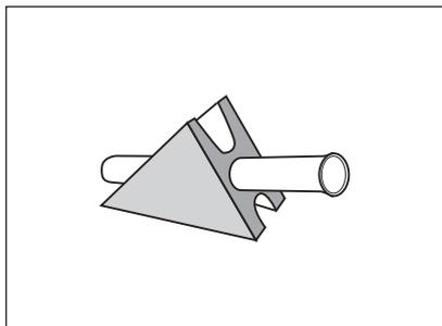
Verwenden Sie anstelle von Unterlagen aus den oben aufgeführten Materialien den optionalen Dreieckshalter. Den Dreieckshalter können Sie von METTLER TOLEDO unter der Nummer 210435 beziehen.
