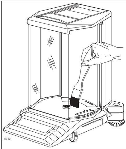
Entfernen Sie die Waagschale und anschliessend die Wägeraumplatte. Reinigen Sie den Wägeraum mit dem mitgelieferten Pinsel.
