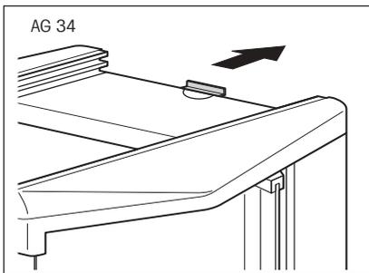
Lösen Sie die Verriegelung des Wägeraumdeckels.
