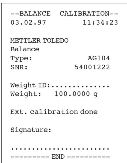
Falls Ihre Waage mit einem Drucker verbunden ist, wird die Justierung automatisch GLP konform protokolliert. Das nebenstehende Protokoll ist ein Muster, ausgedruckt mit dem Drucker METTLER TOLEDO LC-P45. Je nach angeschlossenem Drucker kann der Ausdruck vom gezeigten Beispiel etwas abweichen.
