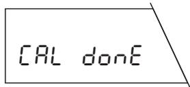
Nach Abheben des Gewichtes zeigt die Waage das Ende des Justiervorgangs an und kehrt anschliessend in den Wägemodus zurück.
