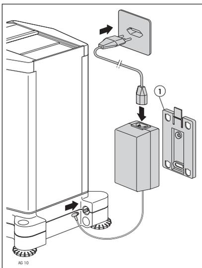
Falls Sie den mitgelieferten Halter (1) für den Netzadapter verwenden möchten: Bringen Sie den Halter mit zwei Schrauben an einer geeigneten, ausreichend stabilen Fläche an (z.B. an der Wand oder an der Unterseite einer Tischplatte). Drücken Sie den Netzadapter in den Halter.
