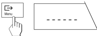
Drücken Sie anschliessend kurz die Taste «E»». Solange die horizontalen Striche angezeigt werden, berechnet Ihre Waage das Referenzgewicht.
