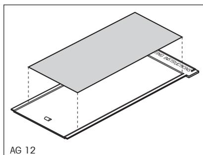
Entfernen Sie den Aufkleber mit der Kurzbedienungsanleitung vorsichtig von seiner Trägerfolie und kleben Sie die Kurzbedienungsanleitung auf den Schieber.
