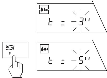
Durch kurzes Drücken der Taste «**F**» können Sie eine der zur Verfügung stehenden Zeitspannen (1, 2, 3, 5, 10 oder 20 Sekunden) wählen.
