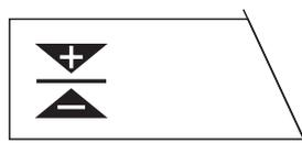
Zur schnellen Erfassung des vorgegebenen Wertes (100%) erscheint in der Anzeige eine optische Einwägehilfe. Wenn das Zielgewicht innerhalb  $\pm 2,5\%$  liegt, sind beide Pfeile sichtbar. Diese Toleranz ist fix eingestellt und kann nur über die Schnittstelle verändert werden.
