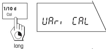
Starten Sie den Justiervorgang durch langes Drücken der Taste «**Cal**». Die Waage zeigt kurz an, dass mit externen Gewichten justiert wird.
