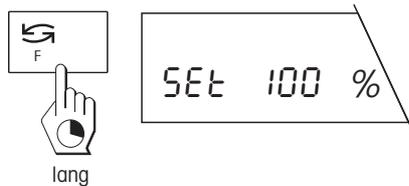
Ihre Waage benötigt ein Referenzgewicht, das 100 % entsprechen soll. Drücken Sie die Taste «F» und halten Sie sie gedrückt bis Sie zum Auflegen des Referenzgewichtes aufgefordert werden.
