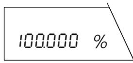
Nach Abschluss des Einwägevorgangs ist Ihre Waage bereit zur Prozentwägung.
