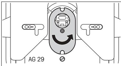
Drehen Sie den Deckel um 180°. Zentrieren Sie das Loch im Deckel genau auf die Aussparung im Boden der Waage.
