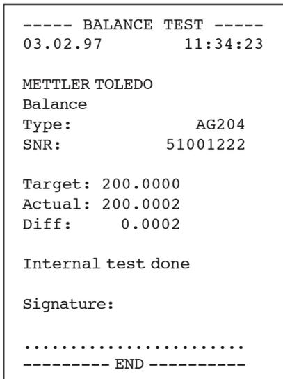
Falls ein Drucker an Ihre Waage angeschlossen ist, wird die ermittelte Abweichung automatisch protokolliert. Das nebenstehende Protokoll ist ein Muster, ausgedruckt mit dem METTLER TOLEDO-Drucker LC-P45. Je nach angeschlossenem Drucker kann die Darstellung vom gezeigten Beispiel etwas abweichen.
