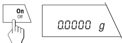
Zum **Einschalten der Waage** drücken Sie **kurz** die Taste «**On/Off**». Sobald die normale Gewichtsanzeige erscheint, ist Ihre Waage wägebereit.
