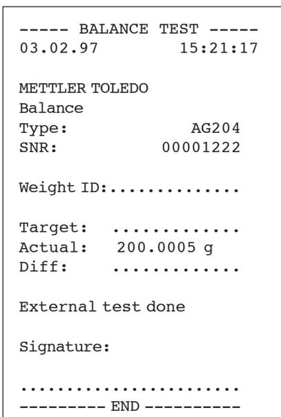
Falls ein Drucker an Ihre Waage angeschlossen ist, wird das ermittelte Gewicht des externen Prüfgewichtes automatisch protokolliert. Sie können jetzt das Sollgewicht "Target" und die Abweichung "Diff" von Hand ins Protokoll eintragen. Das nebenstehende Protokoll ist ein Muster, ausgedruckt mit dem METTLER TOLEDO-Drucker LC-P45. Je nach angeschlossenem Drucker kann die Darstellung vom gezeigten Beispiel etwas abweichen.
