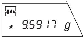
Lesen Sie nach Ablauf der Wägezeit das Resultat ab. In der linken unteren Ecke der Anzeige leuchtet das Sternsymbol "∗". Dieses Symbol zeigt an, dass es sich um den Mittelwert der vorgenommenen Wägungen, also um ein **errechnetes Resultat** handelt. Das Resultat verbleibt in der Anzeige, bis das Wägegut entfernt wird. Falls Sie dasselbe Wägegut noch einmal wägen möchten, drücken Sie kurz die Taste «**E**».
