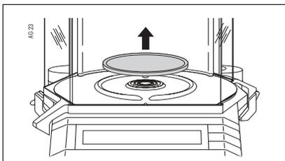
Öffnen Sie den Windschutz und entfernen Sie die Waagschale (bei der AG135, AG285 auch den Windschutzring).
