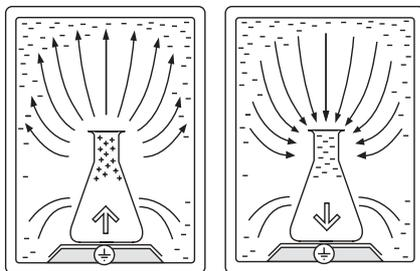
Diese Aufladung tritt häufig in beheizten Räumen mit **trockener Luft** (weniger als ca. 40% rel. Feuchte) und bei Wägegütern aus **Glas** oder **Kunststoff** auf. Elektrostatische Aufladung erzeugt Kräfte, die die Wägung stören können. Dies führt zu stets wechselnden und unstabilen Anzeigeresultaten.
