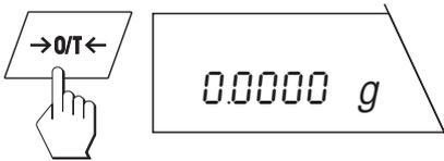
Drücken Sie die Taste «→0/T←», um die Waage zu tarieren.
