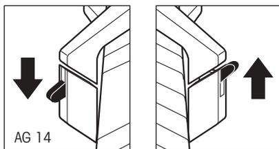
**Beispiel:** Wenn Sie den Windschutz mit der linken Hand bedienen und die Waage mit der rechten Hand beschicken wollen (dies entspricht der üblichen Bedienungsweise für Rechtshänder), schieben Sie das rechte Kupplungselement nach oben und das linke nach unten.
