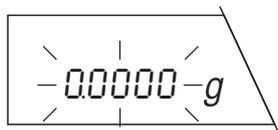
Nach Abschluss des Justiervorgangs werden Sie aufgefordert das Gewicht abzuheben. Entfernen Sie das Gewicht von der Waagschale.
