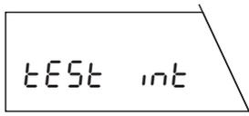
Lösen Sie den Prüfvorgang durch langes Drücken der Taste «**Cal**» aus. Die Waage bestätigt kurz, dass die Überprüfung mit dem internen Gewicht erfolgt.
