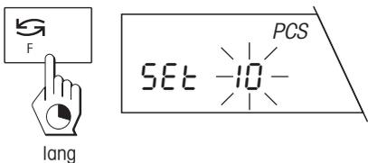
Ihre Waage braucht jetzt das Gewicht einer **Referenzstückzahl**. Drücken Sie die Taste «F» und halten Sie sie gedrückt bis Sie zum Auflegen der Referenzstücke aufgefordert werden.
