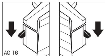
Wenn Sie beide Windschutztüren einzeln öffnen und schliessen wollen, schieben Sie **beide Kupplungselemente in die untere Position**. Bedingt durch den Platzbedarf für das Einfahren der Türen lässt sich jeweils nur eine der beiden Türen vollständig öffnen.
