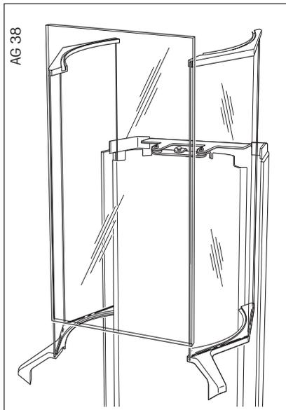
Setzen Sie Ihre Waage in der umgekehrten Reihenfolge wieder zusammen. Achten Sie beim Einsetzen der beiden seitlichen Wägeraumtüren darauf, dass diese korrekt in ihrer Führungsnut liegen. Vergessen Sie nicht, den Wägeraumdeckel zu verriegeln!
