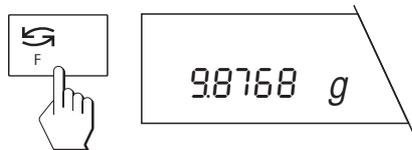
Mit der Taste «F» können Sie jederzeit die Anzeige umschalten zwischen der Stückzahlanzeige, der Wägeinheit 1 und der Wägeinheit 2.
