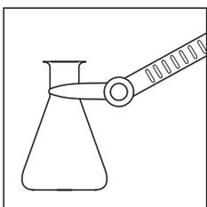
Fassen Sie Wägegüter und Behälter nicht mit der Hand (ca. 35 °C), sondern nur mit einer Zange oder Pinzette an. Fassen Sie nicht mit der Hand in den Wägeraum. So vermeiden Sie Temperaturänderungen, die durch die Körperwärme verursacht werden können.
