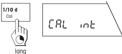
Durch langes Drücken der Taste «**Cal**» lösen Sie den Justiervorgang aus. Die Waage zeigt kurz an, dass mit dem internen Gewicht justiert (kalibriert) wird.
