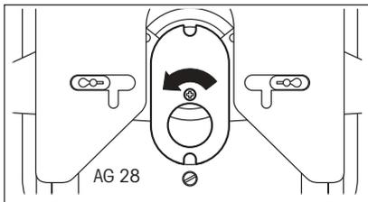
Lösen Sie die Schraube des Deckels der Gehängedurchführung. Sie brauchen die Schraube nur soweit zu lösen, bis Sie den Deckel drehen können.
