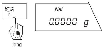
Drücken Sie nochmals die Taste «F» und halten Sie sie gedrückt bis die Waage wieder zur Gewichtsanzeige wechselt. Sie können nun weitere Komponenten einwiegen.
