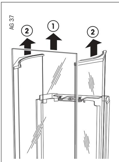
Entfernen Sie das Frontglas (1) und ziehen Sie anschliessend die beiden seitlichen Wägeraumtüren (2) nach oben aus ihrer Führung. Wichtig: Die beiden seitlichen Türen lassen sich nur entfernen, wenn sie sich in der vordersten („geschlossenen“) Stellung befinden!
