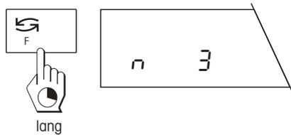
Drücken Sie erneut die Taste «F» und halten Sie sie gedrückt, bis die Anzahl "n" aller bisher eingewogenen Komponenten angezeigt wird.
