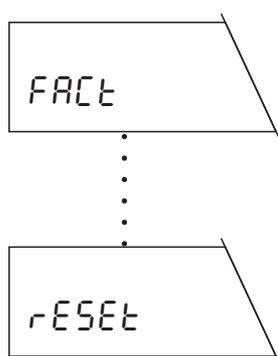
In der Anzeige erscheint der nächste Menüpunkt. Bei jedem Druck auf die Taste «**Menu**» wechselt die Waage zum nachfolgenden Menüpunkt.
