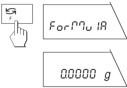
Drücken Sie kurz die Taste «**F**» und in der Anzeige wird bestätigt, dass die Rezeptier-Funktion aktiviert ist.
