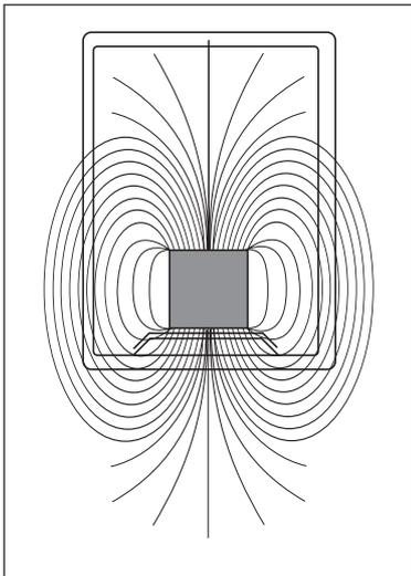
Der Magnetismus eines Wägegutes kann dazu führen, dass das Wägeresultat von der Position des Wägegutes auf der Waagschale abhängt und dass sich das Resultat schlecht wiederholen lässt. Magnetische Kräfte werden von der Waage fälschlicherweise als zusätzliche Last interpretiert.
