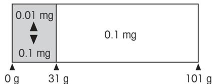
Wenn Sie eine AG 135 oder AG285 besitzen, verfügen Sie über eine Zweibereichswaage ("Dual Range-Waage"). Diese Modelle verfügen zusätzlich über einen Feinbereich (Semimikro-Bereich) von 0 bis 31 g resp. 81 g. In diesem Feinbereich zeigt die Waage das Resultat mit einer höheren Auflösung, d.h. mit einer Nachkommastelle mehr an. Im Gegensatz zu den DeltaRange®-Waagen ist dieser Feinbereich jedoch nicht verschiebbar, d.h. er beginnt immer bei 0 und endet immer bei 31 resp. 81 Gramm.
