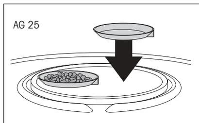
Legen Sie den zusätzlichen Wägebehälter zu den bereits tariierten Wägebehältern auf die Waagschale.
