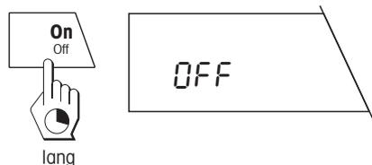
Zum **Ausschalten der Waage** drücken Sie die Taste «**On/Off**» und halten Sie diese gedrückt, bis in der Anzeige die Meldung "OFF" erscheint.
