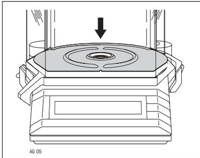
Führen Sie die Wägeraumplatte (mit der geraden Kante gegen vorne und den Erhebungen nach oben gerichtet) in den Wägeraum ein. Drücken Sie die Platte bis zum Anschlag nach unten.
