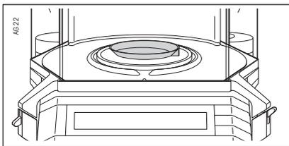
Falls Sie mit einem Wägebehälter arbeiten, legen Sie ihn im normalen Wägemodus auf die Waagschale.
