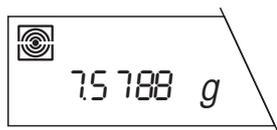
Drücken Sie kurz die Taste « $\rightarrow$ ». Sobald das Wägeresultat stabil ist, erlischt die Statusanzeige der Wiederholbarkeit und das Resultat wird zum angeschlossenen Gerät übertragen.
