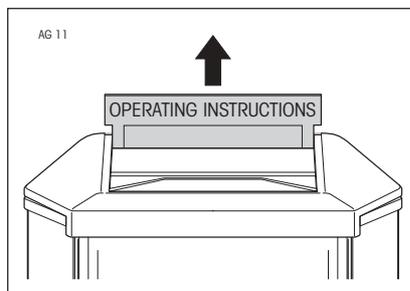
Ziehen Sie den Schieber für die Kurzbedienungsanleitung nach oben aus der Waage (Sie müssen dazu einen kleinen Widerstand überwinden, der als Anschlag dient). Legen Sie den Schieber auf eine ebene Unterlage.
