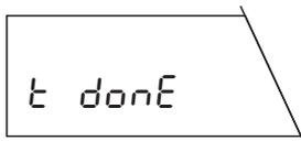
Die Waage bestätigt, dass der Test durchgeführt wurde.
