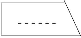
Die Trierung läuft automatisch ab. Falls Sie die Waage in unstabilem Zustand tarieren, wird der Triervorgang in der Anzeige durch waagrechte Segmente angezeigt.
