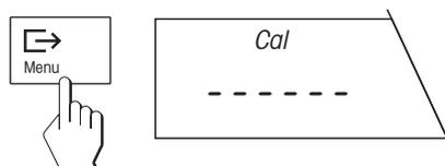
Bestätigen Sie das gewählte Gewicht mit der Taste «**Menu**». Damit lösen Sie den Justiervorgang aus. Die Waage bestimmt den Nullpunkt.
