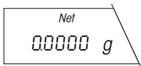
Nach dem Einwägen der ersten Komponente wird die Anzeige auf Null zurückgesetzt und die Waage ist jetzt bereit für das Einwägen der zweiten Komponente.
