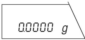
Drücken Sie die Taste «→0/T←», um die Waage zu tariieren.
