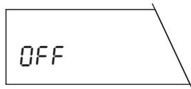
Die Waage führt nun einen Selbsttest durch, bei dem alle Anzeigesegmente aufleuchten. Anschliessend erscheint in der Anzeige "OFF" ("OFF" zeigt an, dass die Waage vom Stromnetz getrennt war).
