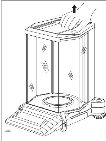
Tragen Sie die Waage zum gewählten Standort. Öffnen Sie die obere Windschutztüre und fassen die Waage am hinteren Steg, oder...
