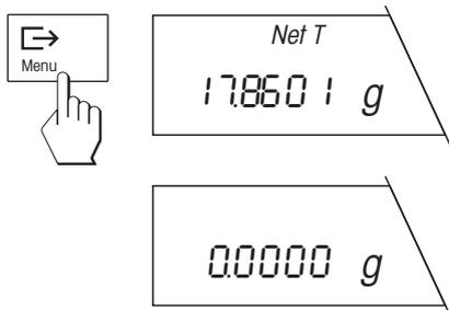
Sobald Sie alle Komponenten eingewogen haben, drücken Sie kurz die Taste «Menu». Damit beenden Sie den Rezeptvorgang. Das Gesamtgewicht aller Einzelkomponenten wird kurz angezeigt.
