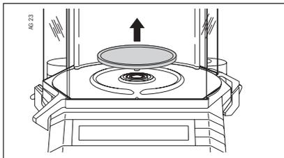
Entfernen Sie die Waagschale (bei der AG135, AG285 auch den Windschutzring).
