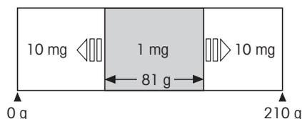
Die nebenstehende Abbildung zeigt das Prinzip des verschiebbaren Feinbereichs in dem eine Nachkommastelle mehr angezeigt wird (in diesem Beispiel umfasst der verschiebbare Feinbereich 81 Gramm).
