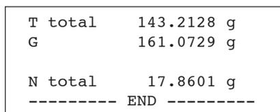
Falls Sie am Ende des Rezeptvorgangs die Resultate ausdrucken, werden alle Taragewichte aufsummiert und das Gesamtgewicht aller Tarabehälter "T total" wird protokolliert.
