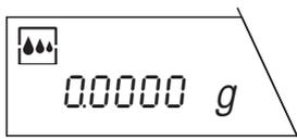
Drücken Sie kurz die Taste «F». Das Symbol des Wägeprozessadapters in der Anzeige bestätigt, dass das dynamische Wägen aktiviert ist.
