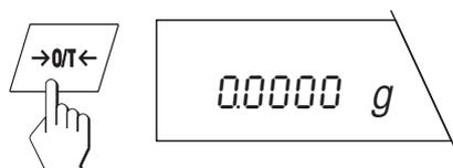
Drücken Sie kurz die Taste «<math>\rightarrow 0/T \leftarrow</math>». Die Waage wird jetzt mit dem zusätzlichen Gewicht des neuen Wägebehälters tariiert. Falls Ihre Waage mit einem Drucker verbunden ist, wird das Taragewicht des neuen Behälters ausgedruckt. Sie können nun weitere Komponenten einwiegen.
