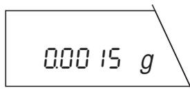
Die Waage zeigt das Resultat in der **Wä geeinheit 1** an.
