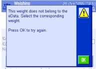
Toutes les données d'étalonnages nécessaires sont stockées dans un code datamatrix (eData) relié au poids correct via l'UIN. Pour tester facilement la balance, le code est imprimé sur la carte WeightLink™ ou bien collé sur la boîte du poids.
