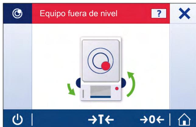
Después de seguir las instrucciones, el asistente de nivelación mostrará los siguientes pasos. Complete todos los pasos hasta que la balanza esté nivelada.
