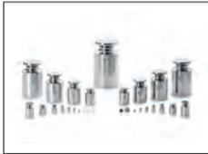
Pesas OIML / ASTM (con certificado de calibración)
